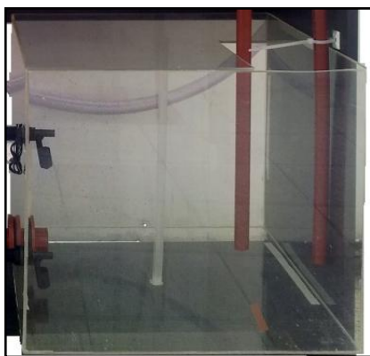
Figura 5.2: Tanque de succión Fuente: Ana Belén Ojeda
