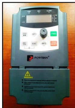
Figura 4.9: Variador de frecuencia 1HP 220VAC Fuente: Ana Belén Ojeda
