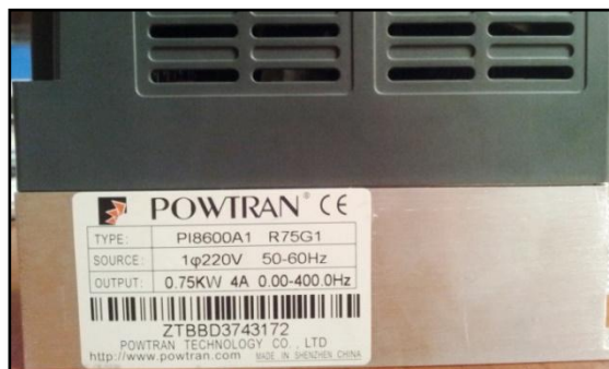
Figura 4.10: Placa de variador de frecuencia Fuente: Ana Belén Ojeda
