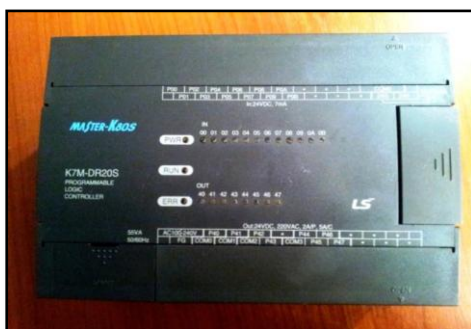
Figura 4.7: PLC Master-K 80S Fuente: Ana Belén Ojeda
