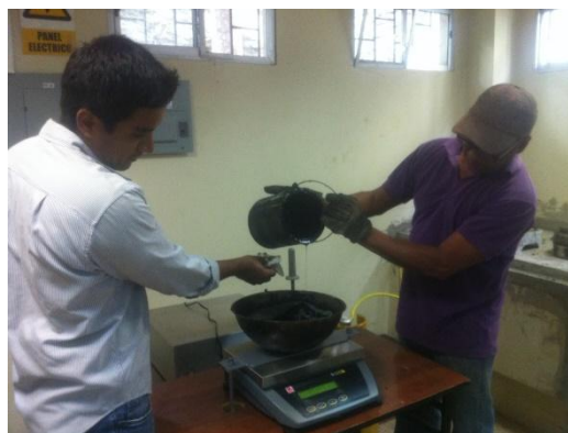
Figura 4-9.- Mezcla de agregados con el ligante asfáltico AC-20
