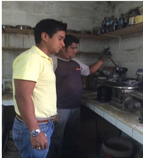
Figura 4-3.- Mezcla de los agregados con el ligante asfáltico.
