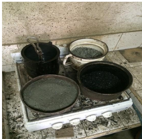
Figura 4-2.- Calentamiento de agregados en cocina de laboratorio de Durán
