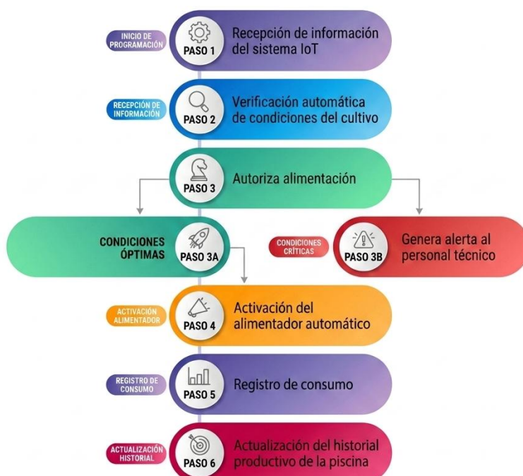
Figura 8. Funcionamiento propuesto del Sistema Automatizado de Alimentación Inteligente
