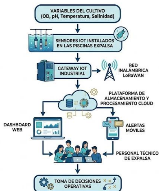
Figura 3. Flujo operativo del Sistema Inteligente de Monitoreo IoT
