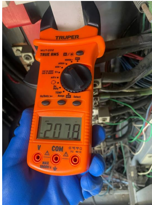
Figura 2-5 Medición de corriente alterna.
