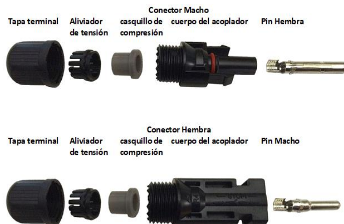
Figura 11. Composición del conector MC4
