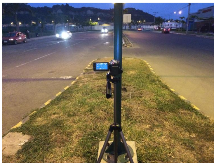
Foto 10. Equipo de conteo utilizado en la entrada a la Urbanización La Joya y Villa del Rey
