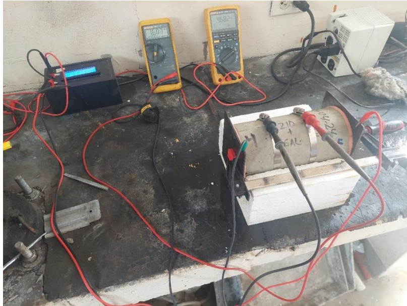
Ilustración 15. Configuración de equipos para medición de Resistividad Volumétrica.
