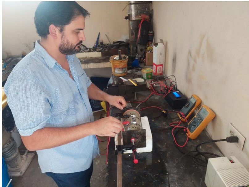
Ilustración 16. Toma de lecturas de Resistividad Volumétrica.
