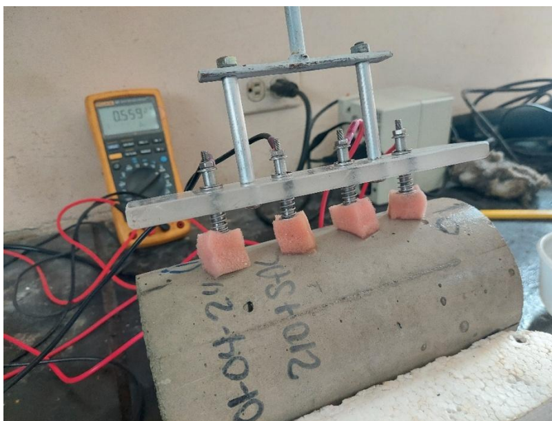
Ilustración 3. Ensayo de resistividad superficial mediante el método de las cuatro puntas.
