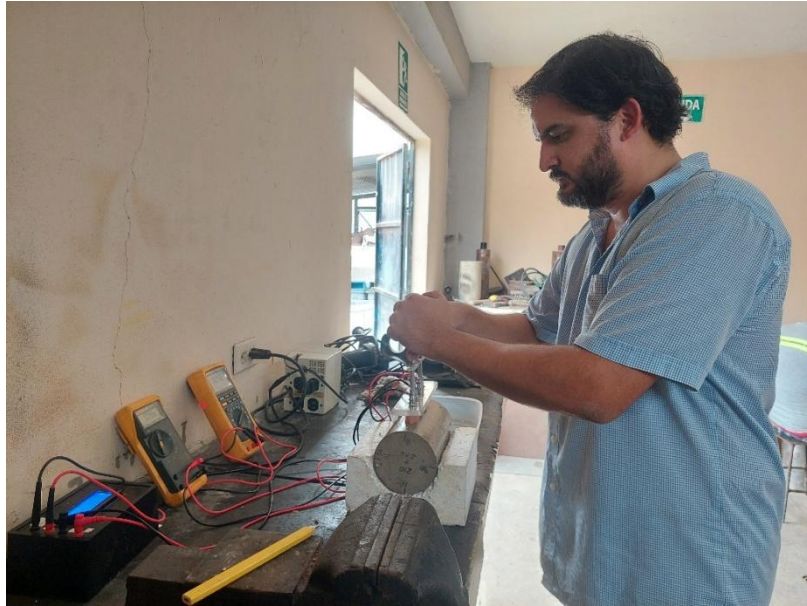
Ilustración 14. Toma de lecturas de Resistividad Superficial.
