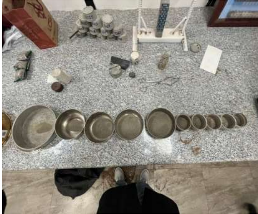
Ilustración 28. Ensayo de granulometría del agregado fino. Fuente: Ilustración propia.
