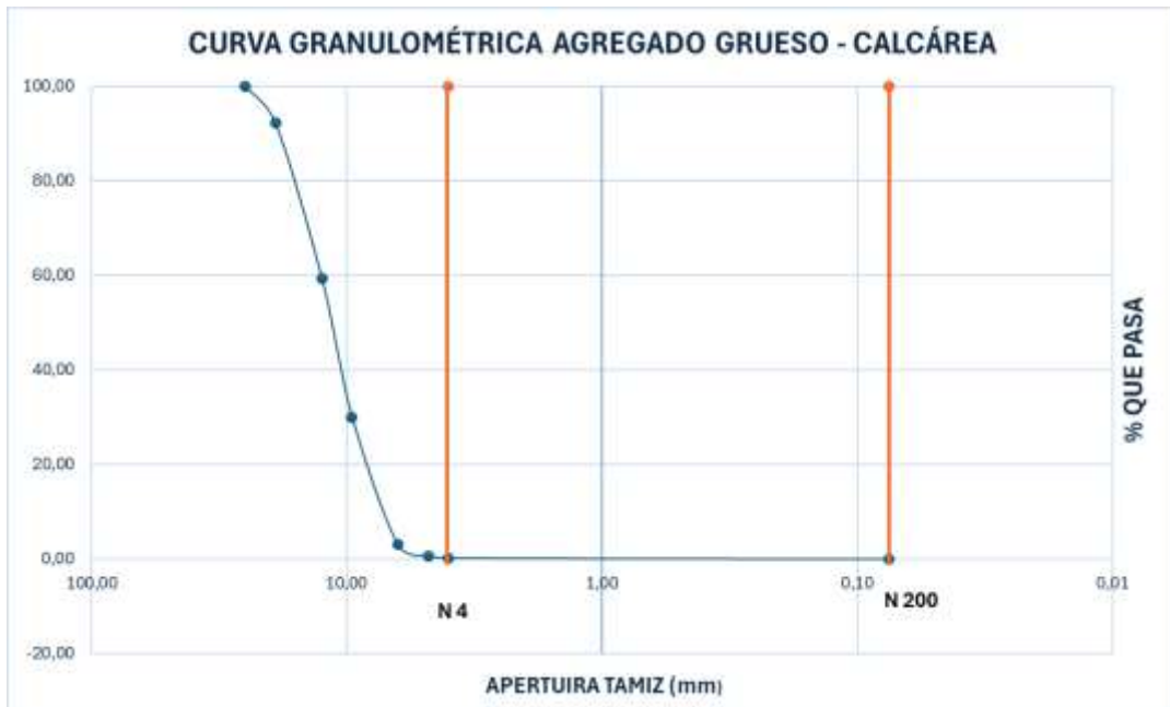
Ilustración 15. Curva granulométrica del Agregado Grueso – calcáreo. Fuente: Ilustración propia.
