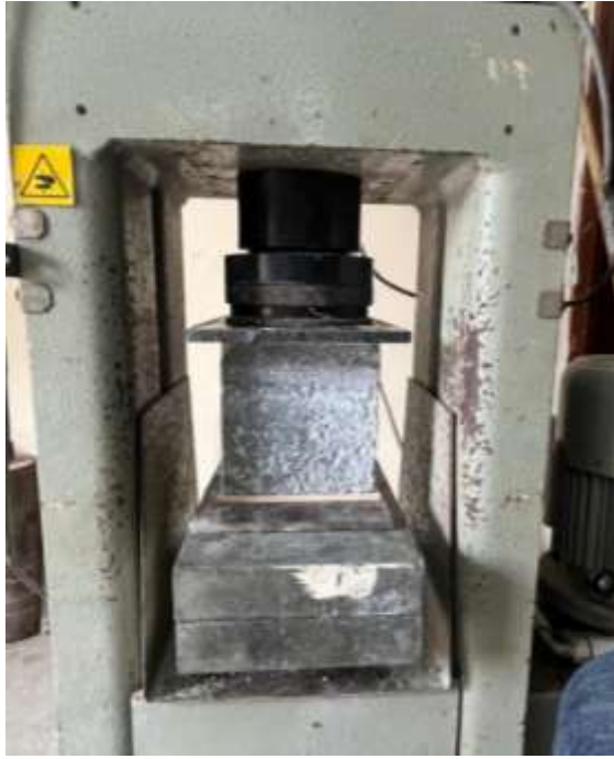
Ilustración 13. Ensayo de resistencia a tracción indirecta. Fuente: Ilustración propia.
