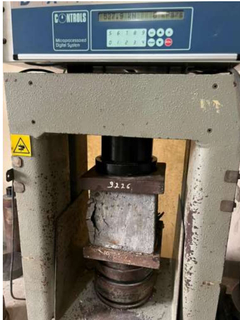
Ilustración 32. Últimos ensayos de compresión a los 51 días. Fuente: Ilustración propia.
