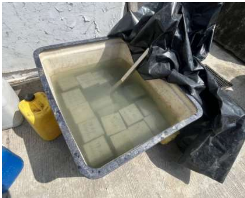
Ilustración 9. Probetas cúbicas y cilíndricas sumergidas. Fuente: Ilustración propia.
