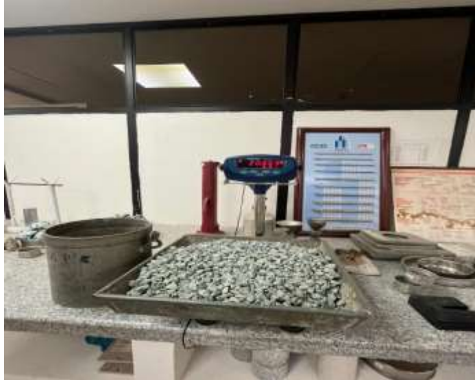
Ilustración 5. Peso Volumétrico Suelto Piedra Basalto. Fuente: Ilustración propia.
