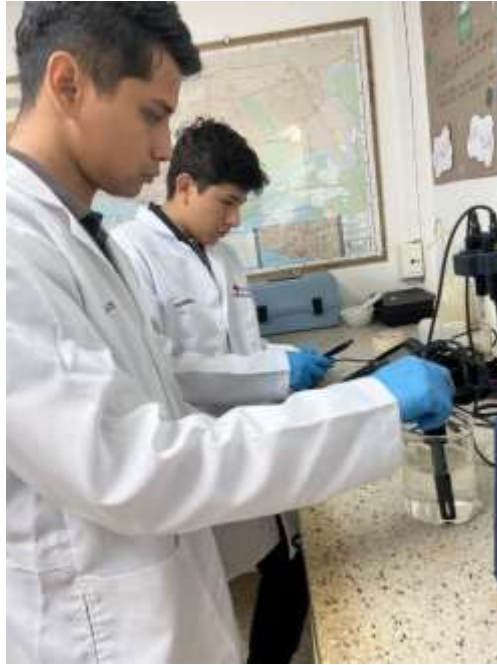
Ilustración 21. Colocación de sondas para determinar parámetros, como el pH, temperatura. Fuente: Ilustración propia.
