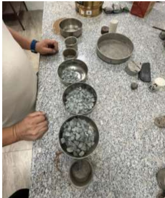
Ilustración 27. Ensayo de granulometría del agregado grueso basalto. Fuente: Ilustración propia.
