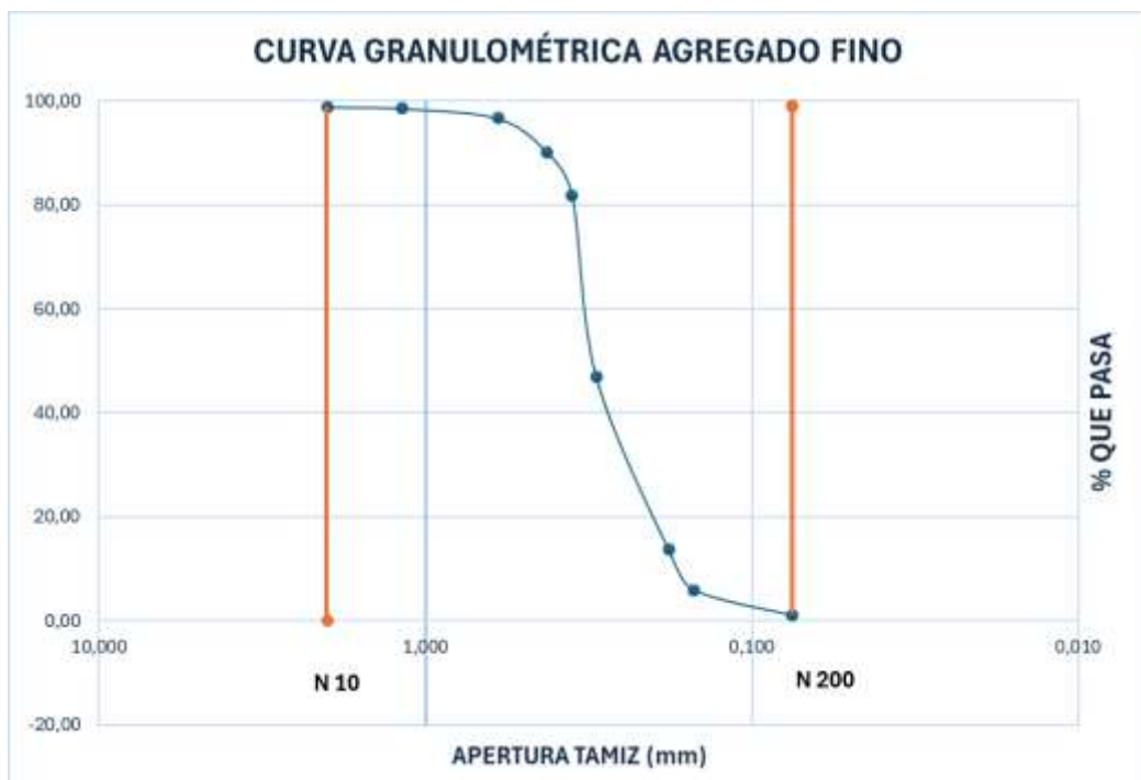
Ilustración 16. Curva granulométrica del Agregado Fino. Fuente: Ilustración propia.
