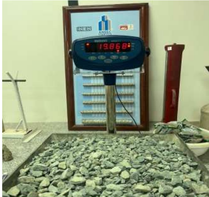
Ilustración 3. Peso volumétrico Suelto Calcárea. Fuente: Ilustración propia.
