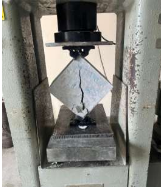
Ilustración 11. Ensayo de resistencia a compresión simple. Fuente: Ilustración propia.
