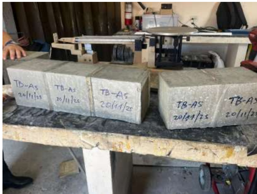
Ilustración 31. Desencofrado de las probetas. Fuente: Ilustración propia.
