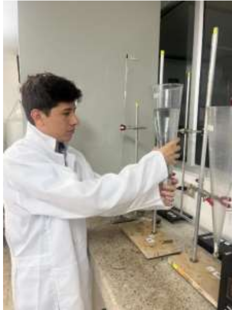
Ilustración 23. Prueba de sólidos sedimentables. Fuente: Ilustración propia.
