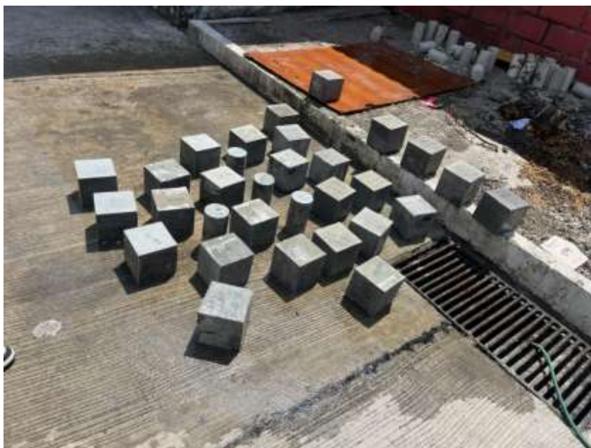
Ilustración 10. Todas las probetas sacadas después de 28 días de curado, para ser ensayadas. Fuente: Ilustración propia.
