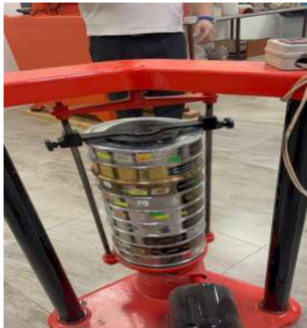
Ilustración 25. Tamizadora Rotatoria para los agregados. Fuente: Ilustración propia.
