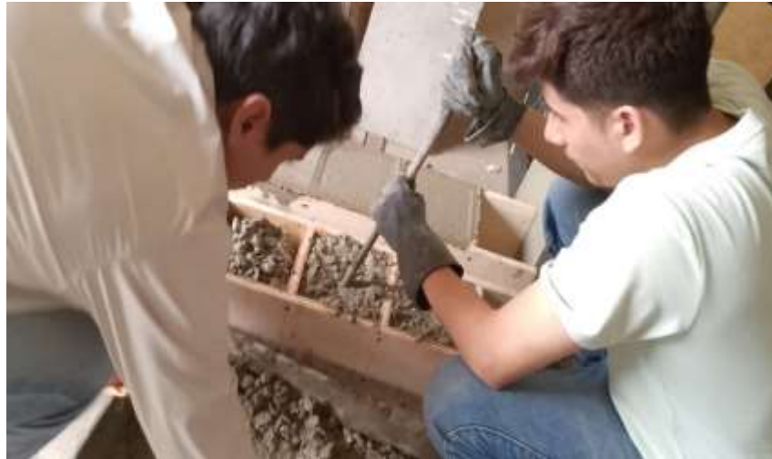
Ilustración 8. Elaboración de todas las probetas cúbicas y cilíndricas de cada Tipo de Hormigón. Fuente: Ilustración propia
