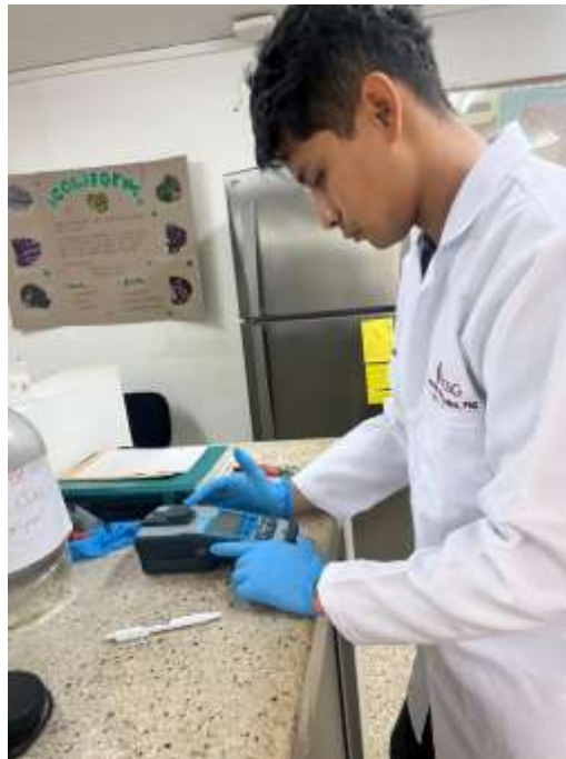
Ilustración 22. Prueba de Turbidez de la muestra. Fuente: Ilustración propia.
