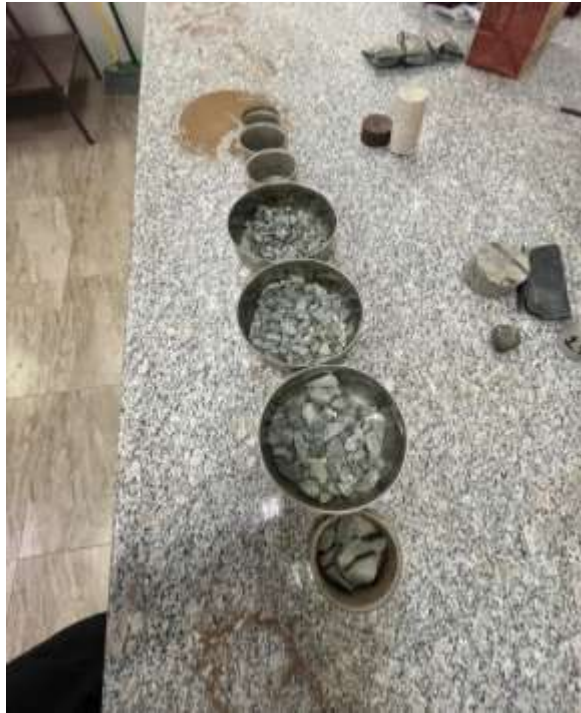
Ilustración 26. Ensayo de granulometría del agregado grueso calcárea. Fuente: Ilustración propia.
