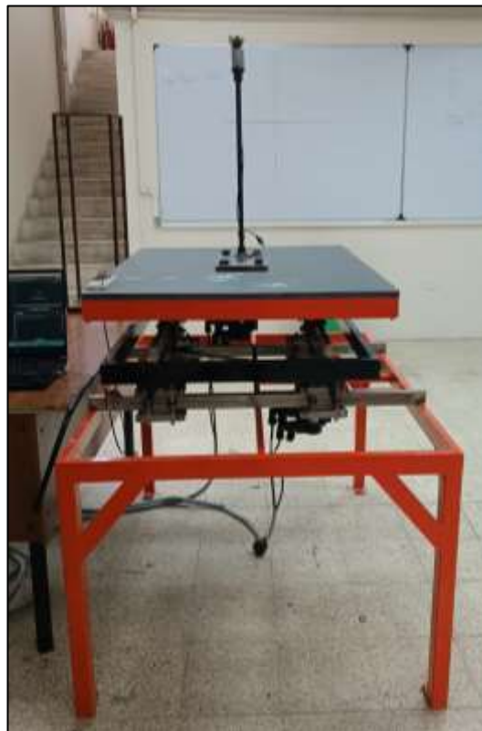
Ilustración 1. Mesa sísmica utilizada para aplicar excitación unidireccional.
