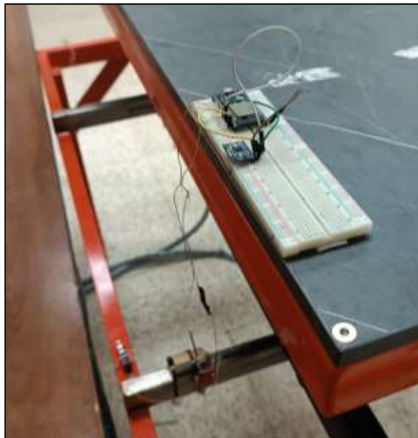
Ilustración 5. Sistema de acelerómetro y sensor de activación en la mesa.
