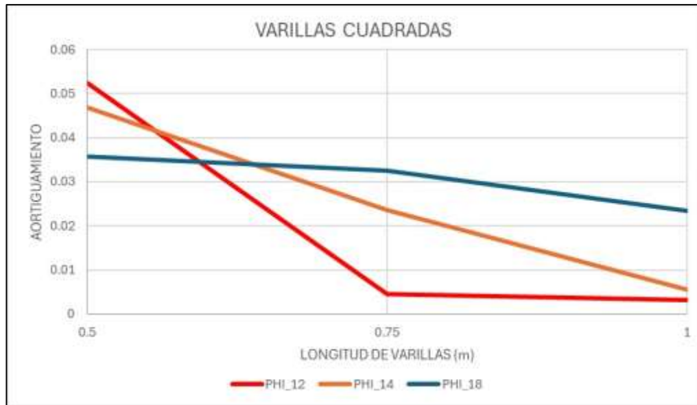
Ilustración 31. Relación del amortiguamiento equivalente con la longitud de varilla en probetas de sección cuadrada.
