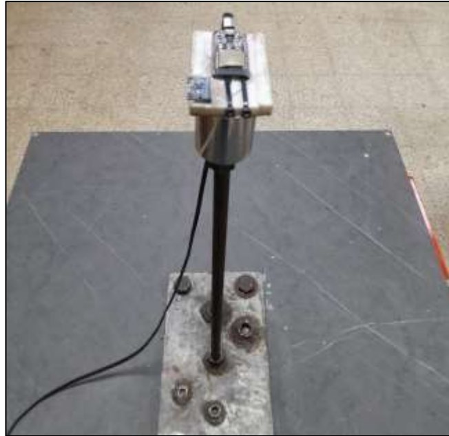
Ilustración 4. Sistema de acelerómetro en masa de probeta.
