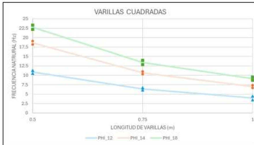
Ilustración 14. Frecuencia fundamental medida: probetas con varilla cuadrada.
