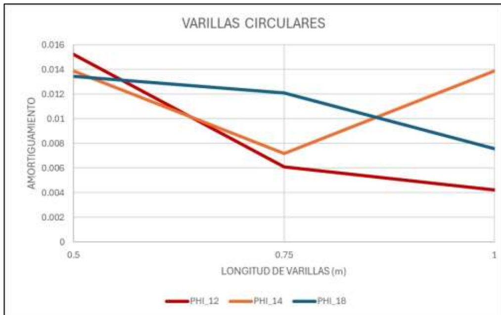
Ilustración 30. Relación del amortiguamiento equivalente con la longitud de varilla en probetas de sección circular.
