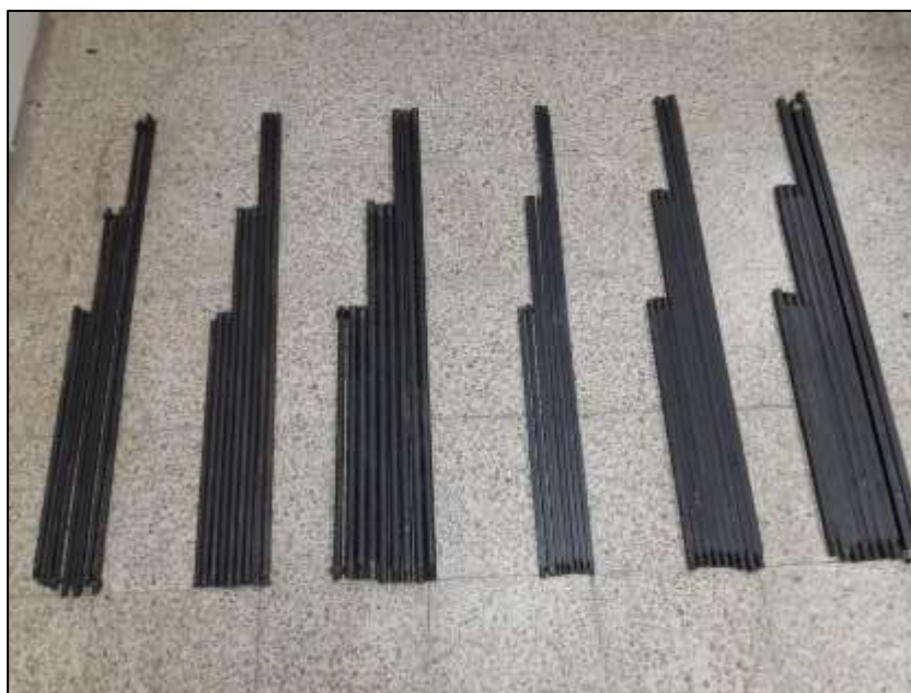
Ilustración 7. Varillas de acero utilizadas como probetas (secciones circular y cuadrada).
