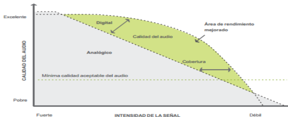
Figura 3.4 Intensidad de la señal vs calidad del Audio.
