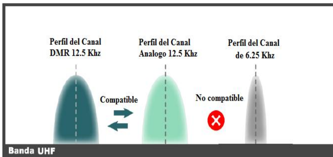
Figura 3.1 Compatibilidad del espectro de guarda con los Antiguos Sistemas Análogos.
