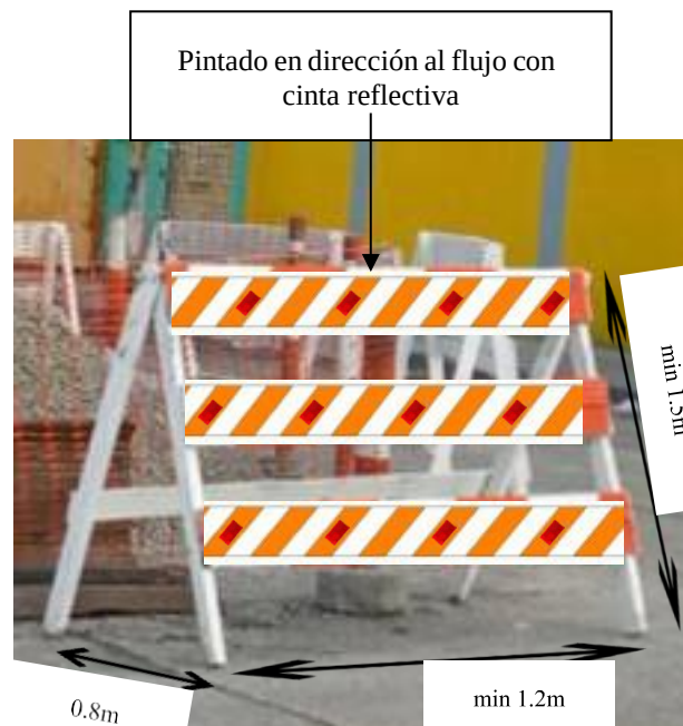
Figura 8. Caballete de madera con dimensiones
