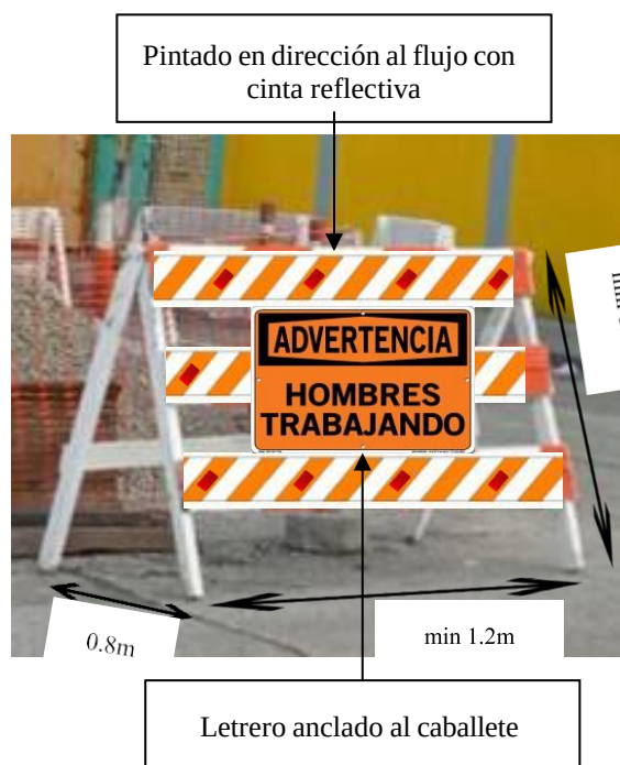
Figura 5. Caballete de madera con letrero de señalización
