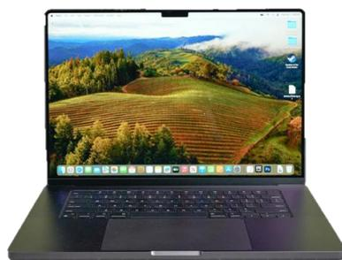
**Procesador:** Es un equipo que cuenta con un procesador Chip M3 Max, CPU de 14 núcleos en donde 10 núcleos se encargan del rendimiento y los otros 4 de la eficiencia operativa
