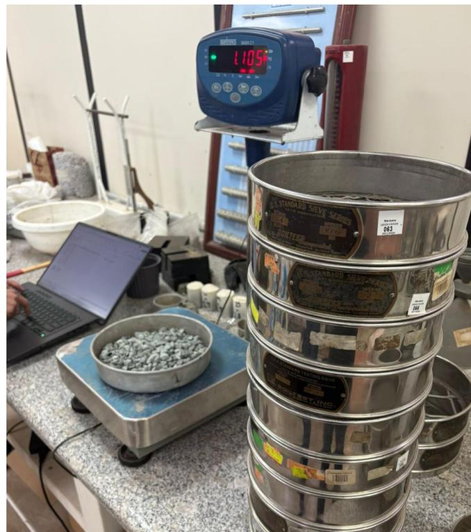
Ilustración 33: Ensayo de Granulometría del agregado grueso. Fuente: Ilustración propia.
