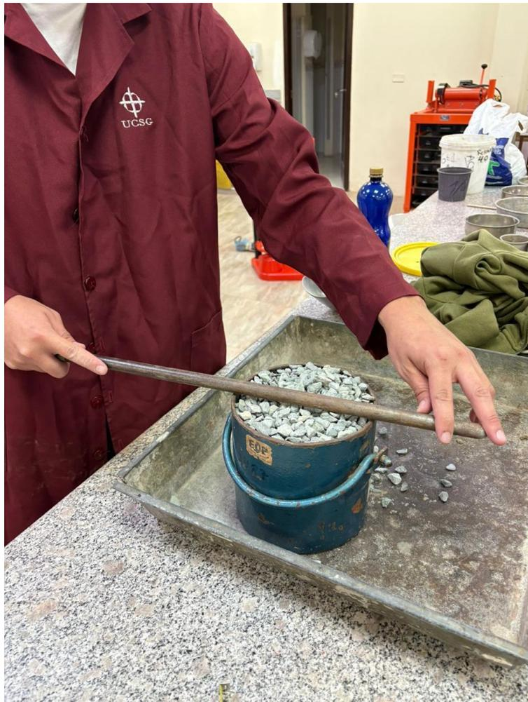
Ilustración 34: Ensayo de Peso Unitario de agregado grueso. Fuente: Ilustración propia.
