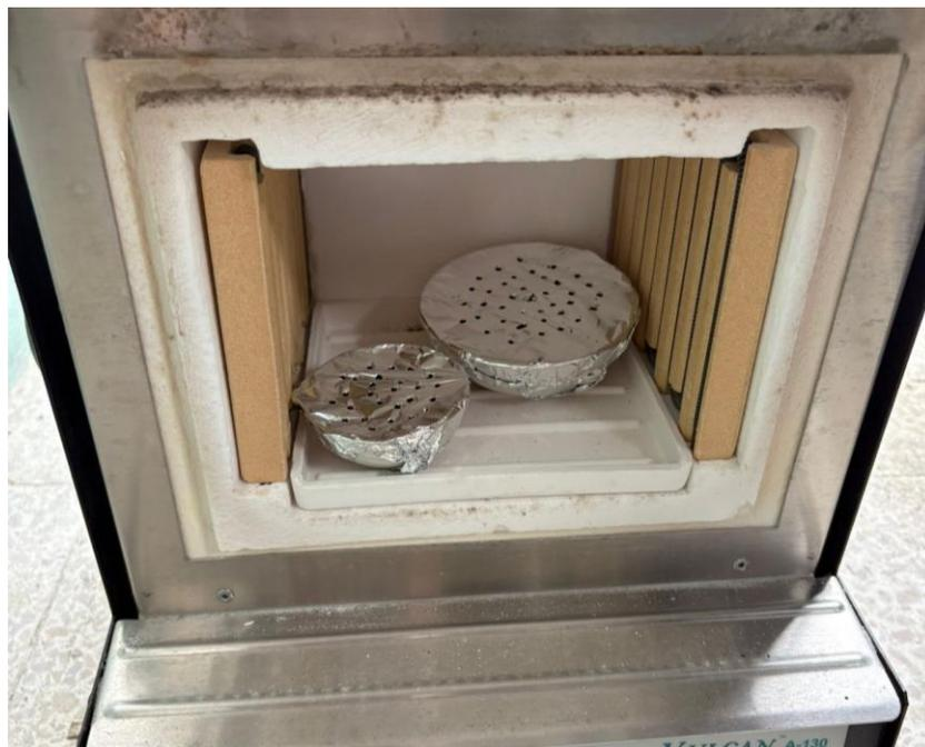
Ilustración 9: Moldes pequeño y grande sometidos a prueba para la obtención del biocarbón.
