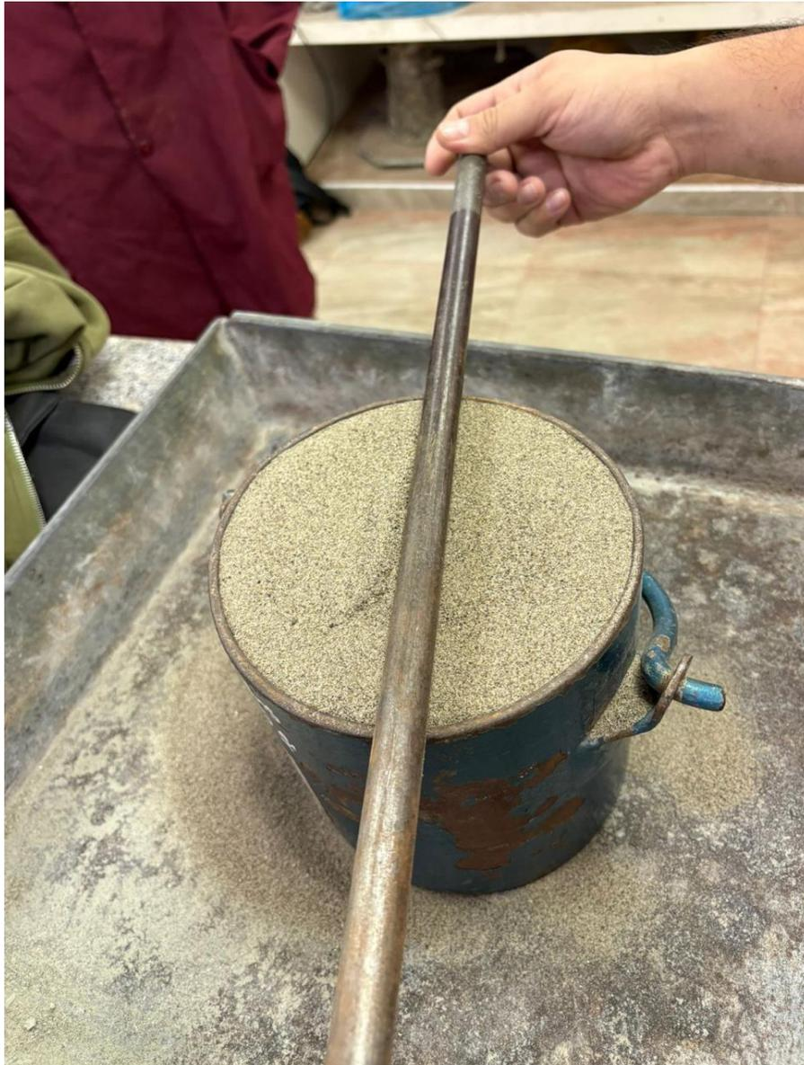
Ilustración 36: Ensayo de Peso Unitario de agregado fino.
