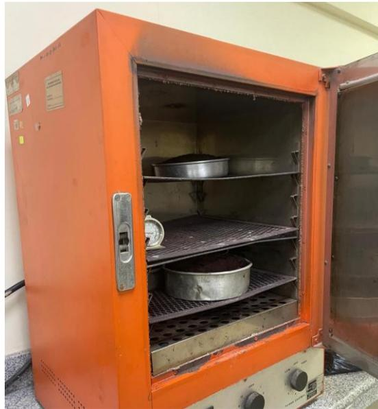
Ilustración 6: Bandejas con residuo de café, listas para su secado en horno.
