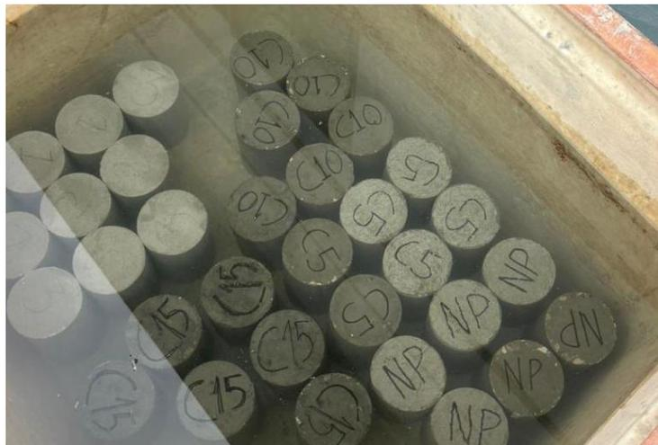
Ilustración 13: Probetas cilíndricas sumergidas. Fuente: Ilustración propia.
