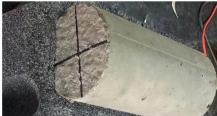
Ilustración 14: Molde confeccionado para ensayo de resistividad eléctrica. Fuente: Ilustración propia.
