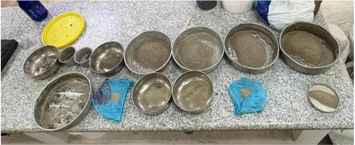
Ilustración 35: Ensayo de Granulometría del agregado fino. Fuente: Ilustración propia.
