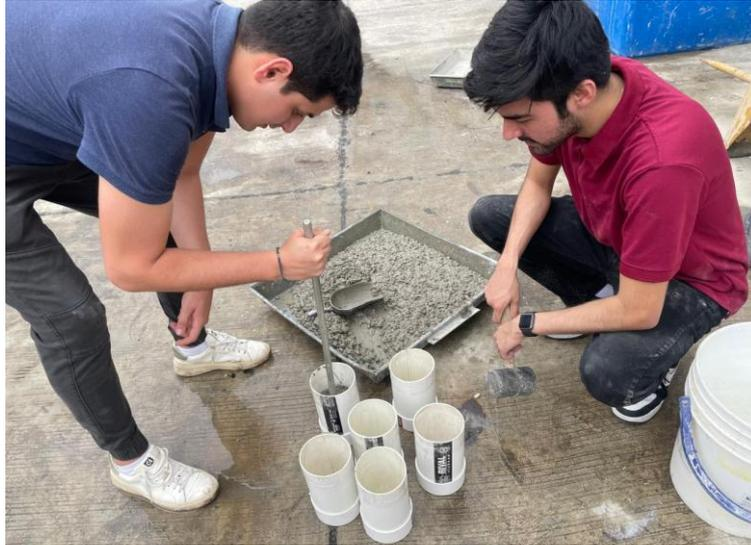
Ilustración 12: Elaboración de probetas cilíndricas de hormigón.
