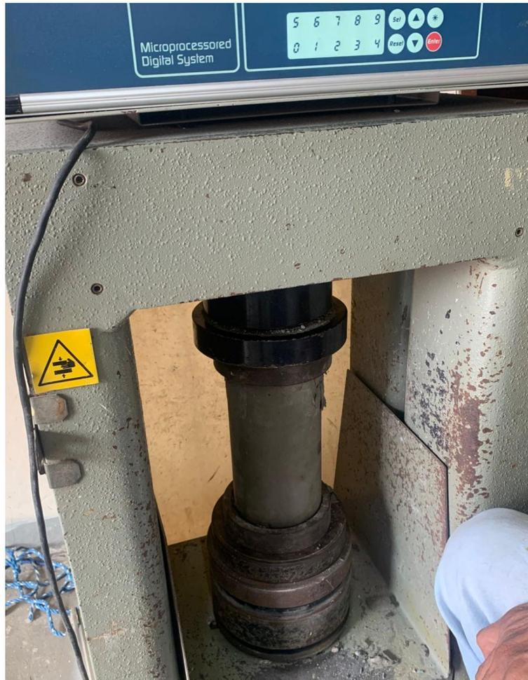
Ilustración 16: Ensayos de resistencia a compresión en las denominadas probetas cilíndricas. Fuente: Ilustración propia.
