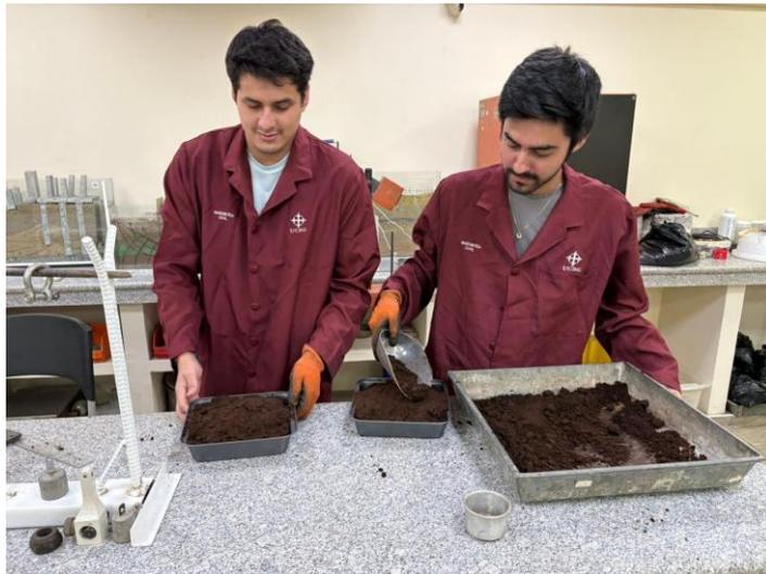
Ilustración 5: Distribución del residuo de café en bandejas para secado en horno.
