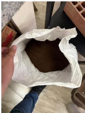
Ilustración 7: Resultado final de residuo previamente secado en horno.
