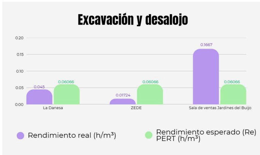
Ilustración 2. Comparación de rendimientos reales vs. rendimiento esperado (PERT) en la actividad "Excavación y desalojo".
