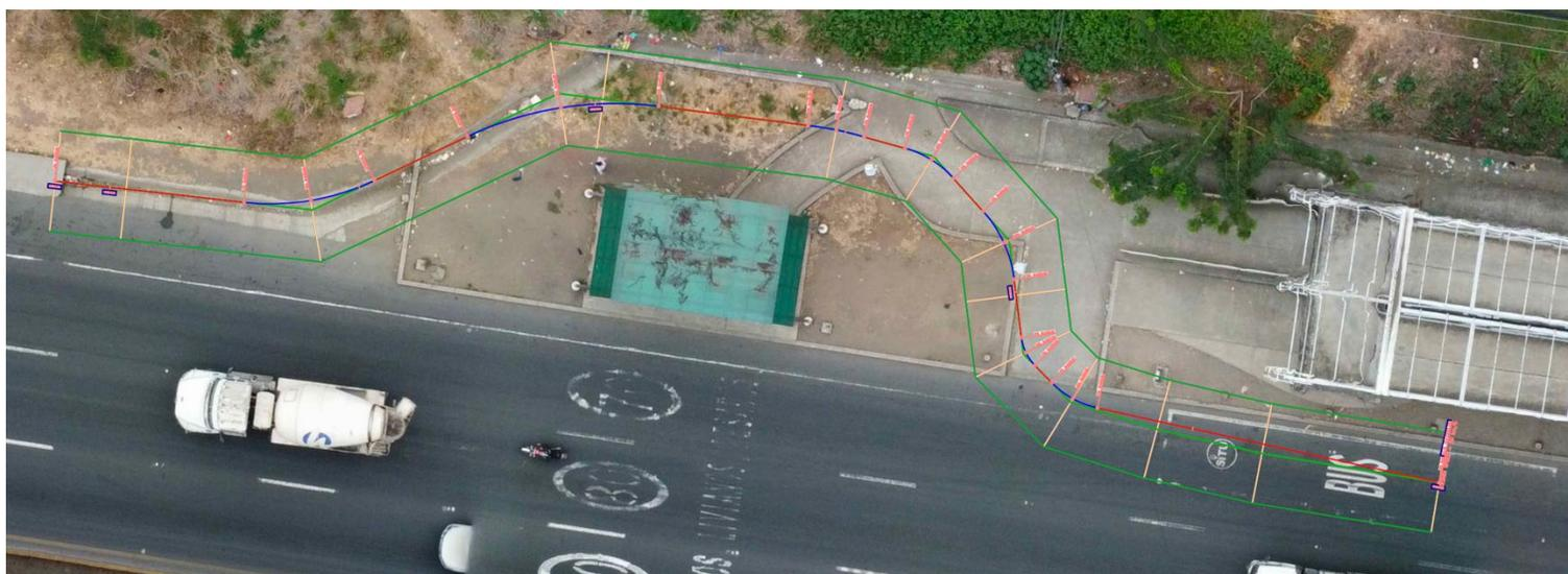
*Ilustración 59. Vista en planta de solución propuesta. Carril de estacionamiento*
