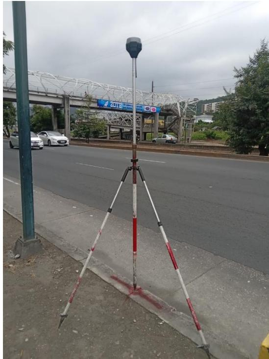
*Ilustración 67. Topografía Vía a la Costa. Sistema RTK. Elaboración propia*
