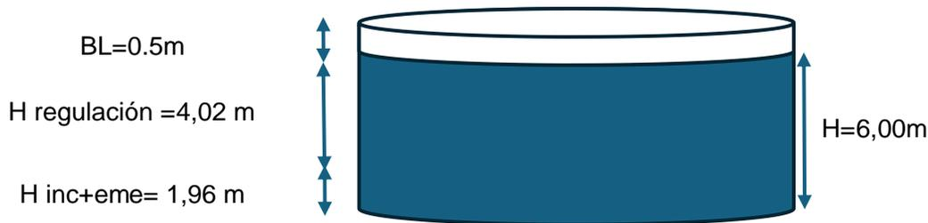
*Ilustración 22 Dimensiones de Tanques Superficiales tipo 2 para Pozos 2, 3, 4, 5, y 6. (Fuente: Autor)*
