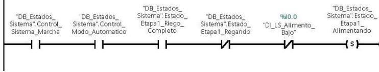
**Network 6: Control del Motor del Carro de Alimento (Avance y Retorno)**
