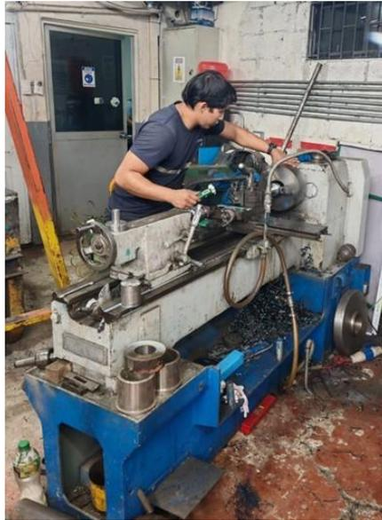
*Nota: Se observa al operador manipulando el torno sin resguardo frontal ni colectores de viruta, lo cual representa riesgos de atrapamiento, corte y proyección de partículas. Además, se evidencia acumulación de virutas metálicas en el área de trabajo, lo que incrementa el peligro de resbalones o cortes. Fuente: Elaboración propia (2025).*
