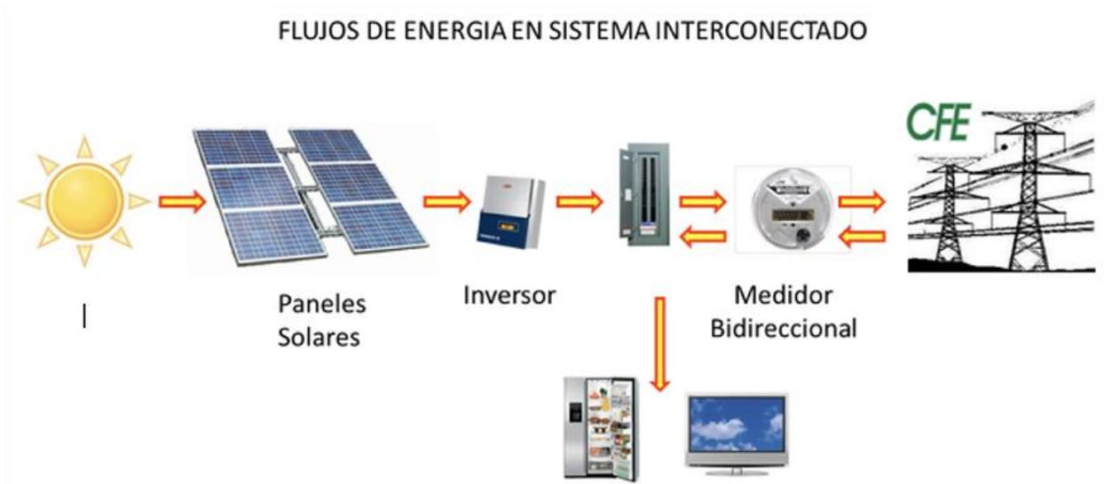
*Figura 2. 33. Sistema fotovoltaico interconectado a la red
