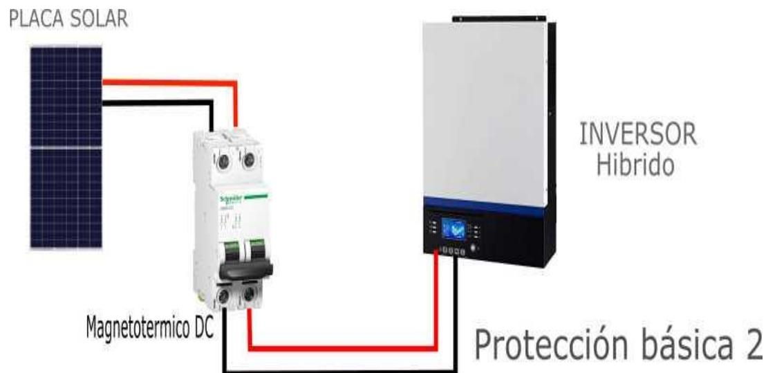
*Nota: La protección DC se encuentra a la salida de los módulos fotovoltaicos y la entrada del inversor, sirve para proteger el inversor de sobre corriente. Adaptado de: (Dután, 2019)*
