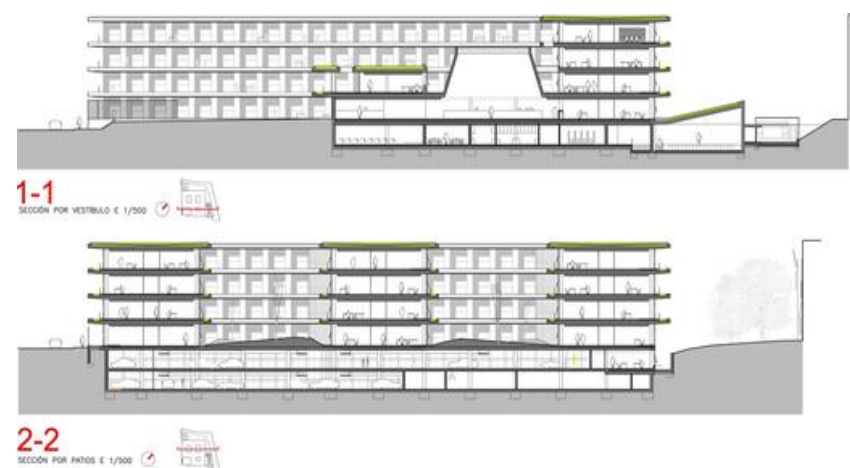
IMAGEN 23: Edificio Administrativo - Secciones FUENTE: Plataforma Arquitectura, 2014
