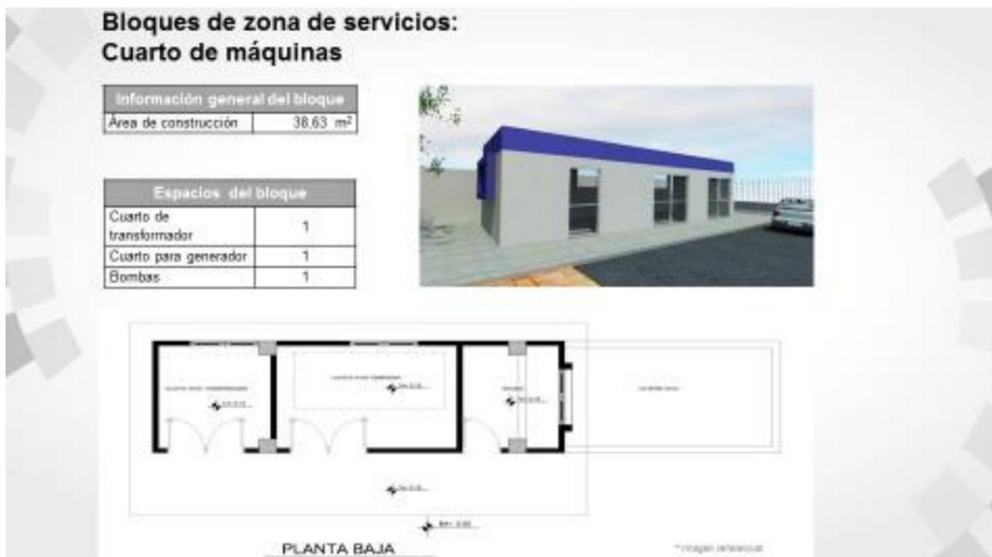
Figura 38. Caracterización Cuarto de Maquinas
