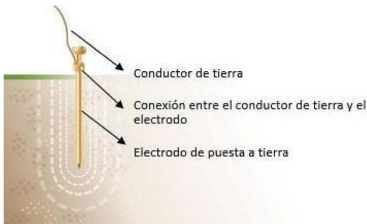
Nota: Partes que se conectan a un electrodo de un sistema de puesta a tierra. Fuente: Ávila, 2019
