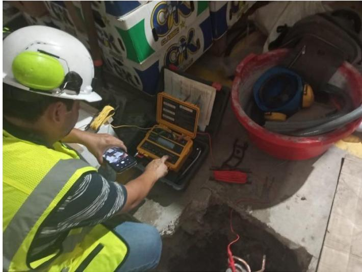
Nota: Ajustes de parámetros para lectura de ohmiaje de las varillas del sistema de puesta a tierra. Foto tomada por: Autor
