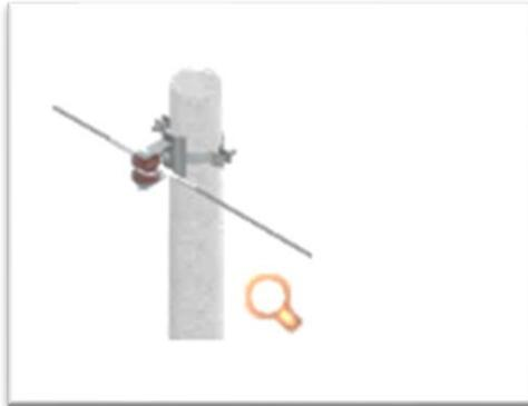
**Nota:** En la figura se observa físicamente la estructura pasante neutro del sistema eléctrico, (Ministerio de Electricidad, Unidades de propiedad, 2024).
