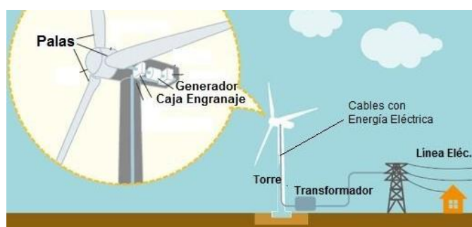
Figura 5: Partes de un aerogenerador.
