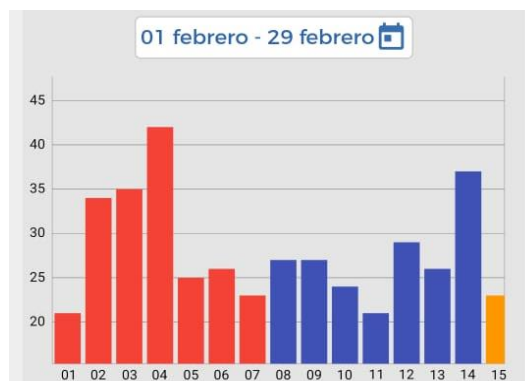
Figura 51: Análisis de consumo eléctrico en kWh del mes de febrero del día 1 al 15 del 2024.
