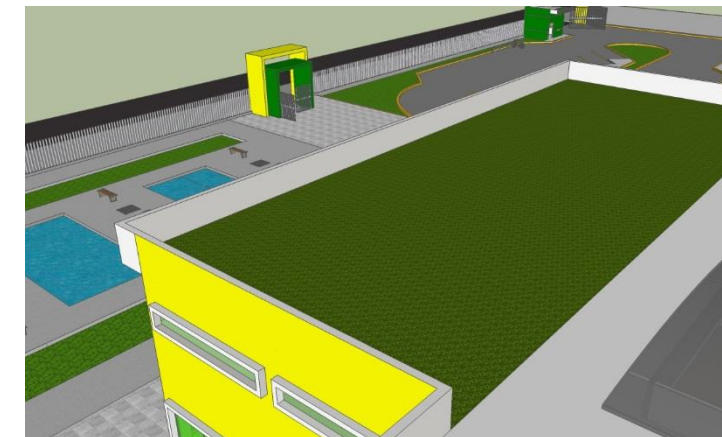
Figura 48. Bloque 2, colocación de cubiertas verdes para generar climatización al interior. Elaborado: José Javier Zambrano Chávez, 2014
