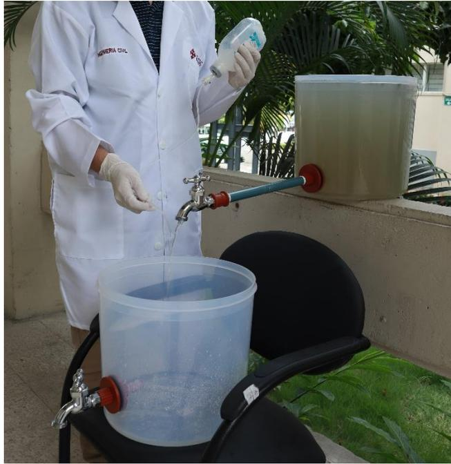
*Ilustración 18 Vertido de la dosificación de sulfato de aluminio. Fuente: Autor.*
