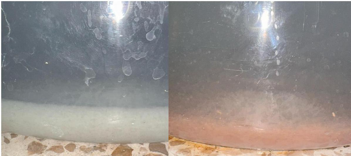
*Ilustración 31 Lodos sedimentados en el fondo de los tanques en las pruebas piloto de sulfato de aluminio y cloruro férrico. Fuente: Autor*
