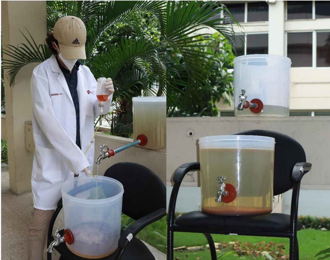
*Ilustración 20 Dosificación y decantación con cloruro férrico. Fuente: Autor*
