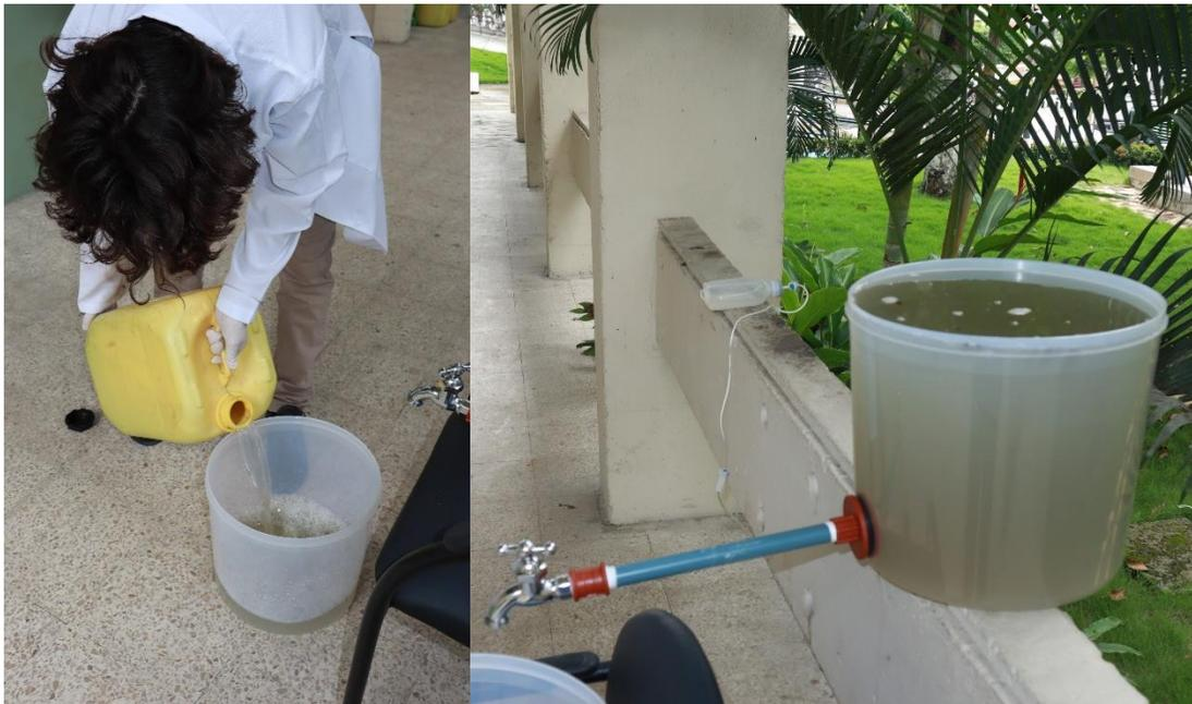
*Ilustración 17 Agua cruda para prueba piloto con sulfato de aluminio. Fuente: Autor*
