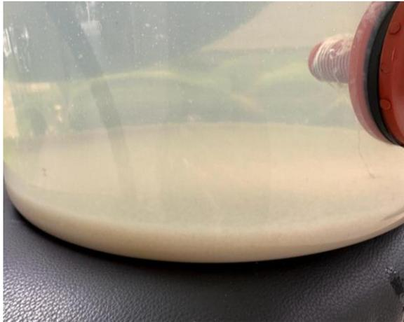
*Ilustración 19 Decantación de los lodos sedimentarios. Fuente: Autor.*
