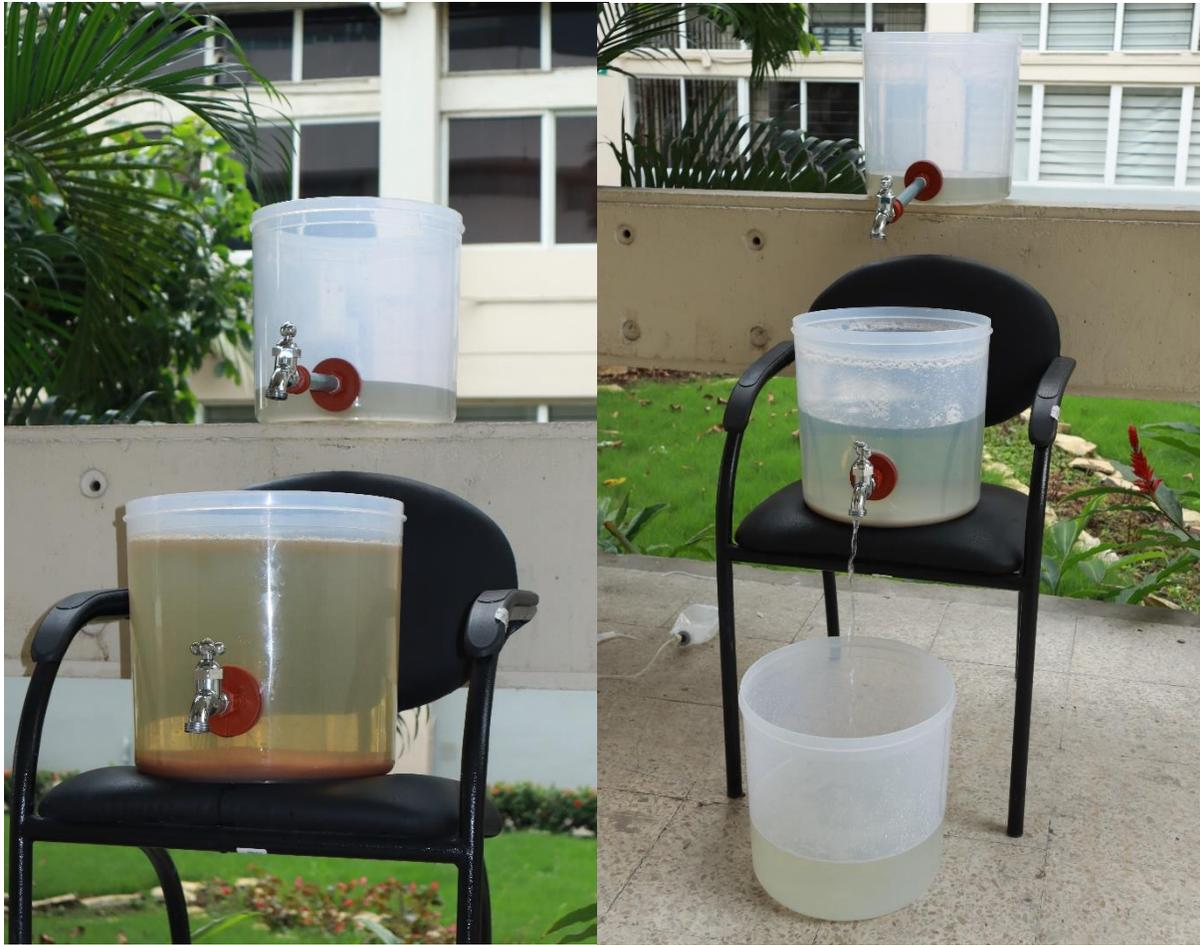
*Ilustración 30 Pruebas piloto de cloruro férrico y sulfato de aluminio. Fuente: Autor.*
