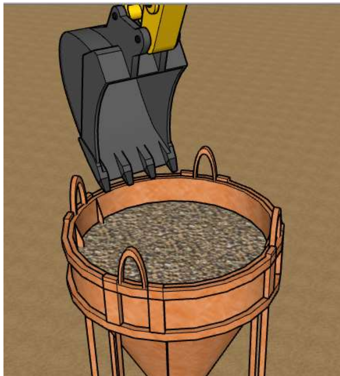
Figura 48. Llenado del geotextil con piedra, usando el embudo.
