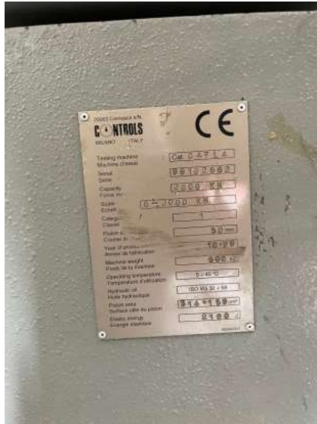
Figura 66. Características de la máquina de prueba de fuerza compresiva simple utilizada para los ensayos.
