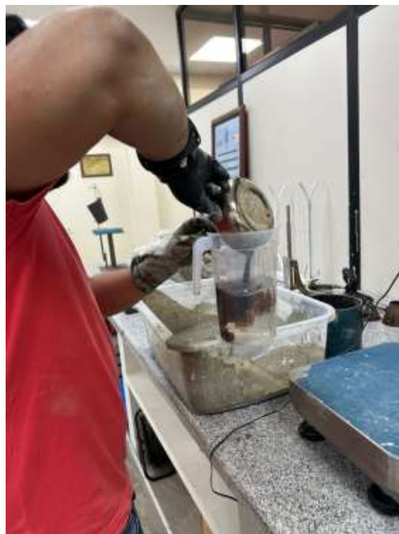
Figura 57. Cuantificación y mezcla del aditivo plastificante.
