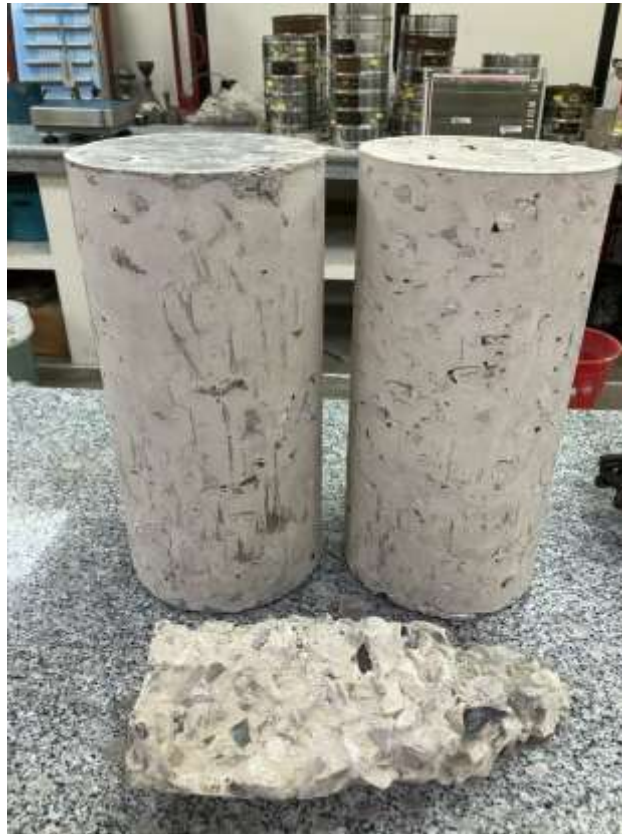
Figura 83. Pedazo de probeta de hormigón después de la rotura durante el ensayo de compresión simple.
