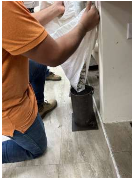
Figura 77. Llenado de los moldes con piedra.
