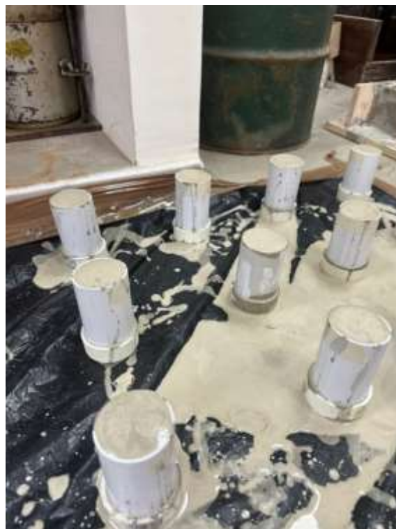
Figura 59. Llenado de los moldes con lechada de cemento.
