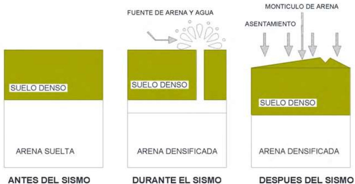
Figura 10. Flotación y ahuellamiento de depósitos de arena en licuación.
