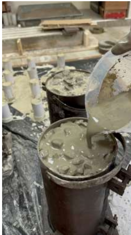
Figura 78. Llenado de los moldes con lechada de cemento.
