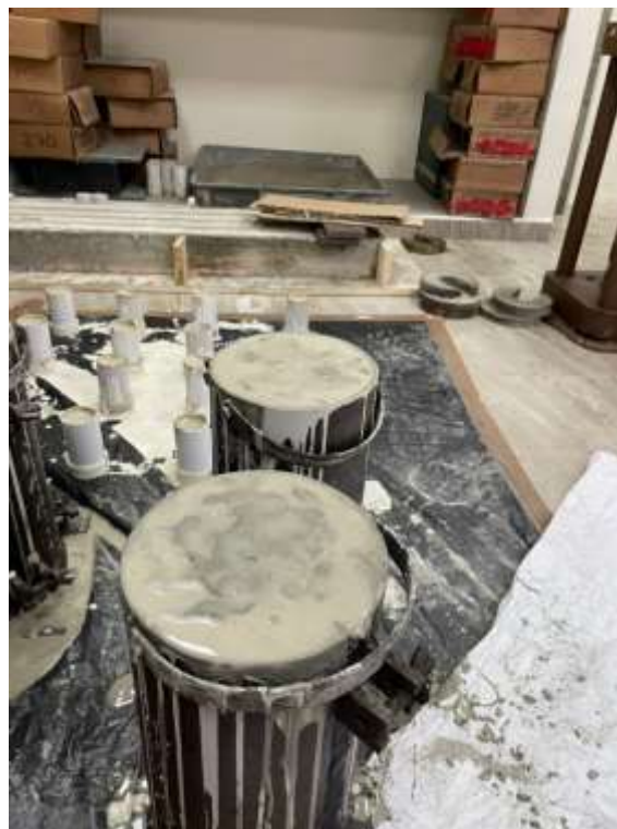
Figura 79. Finalización del llenado de los moldes.
