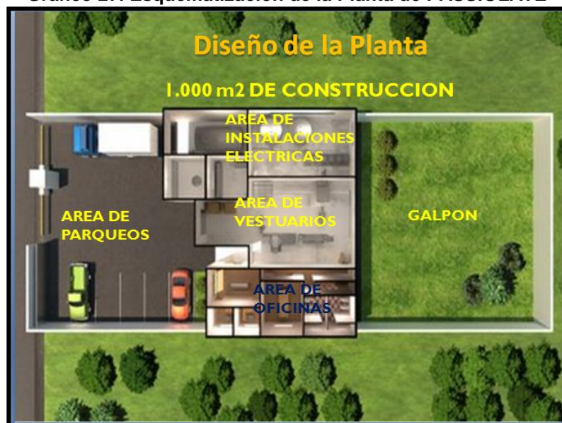
Gráfico 27. Esquematación de la Planta de PASSIOLATE
