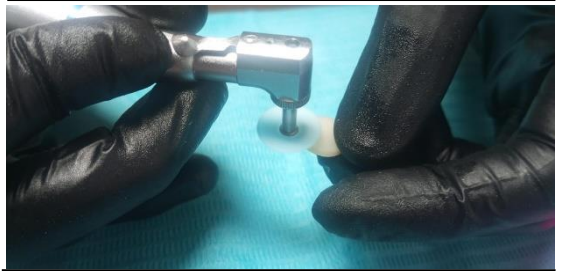
Figura.3. Se pulió 40 cilindros de resina con sistema de pulido Sof-Lex
