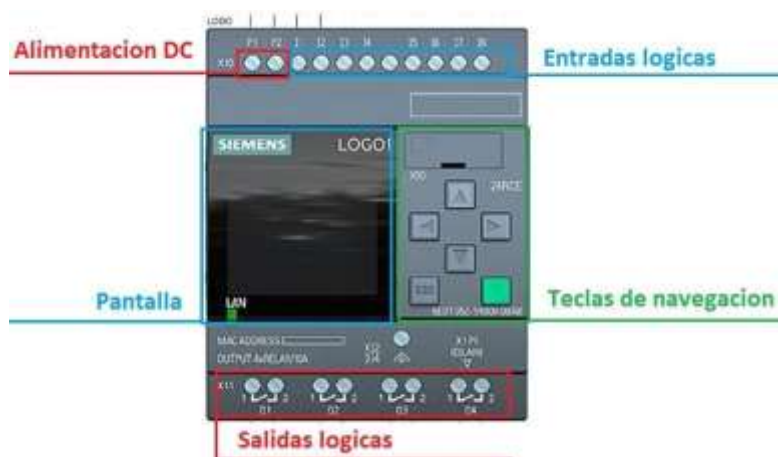
Figura 2. 20. Diagrama de un PLC LOGO de Siemens.
