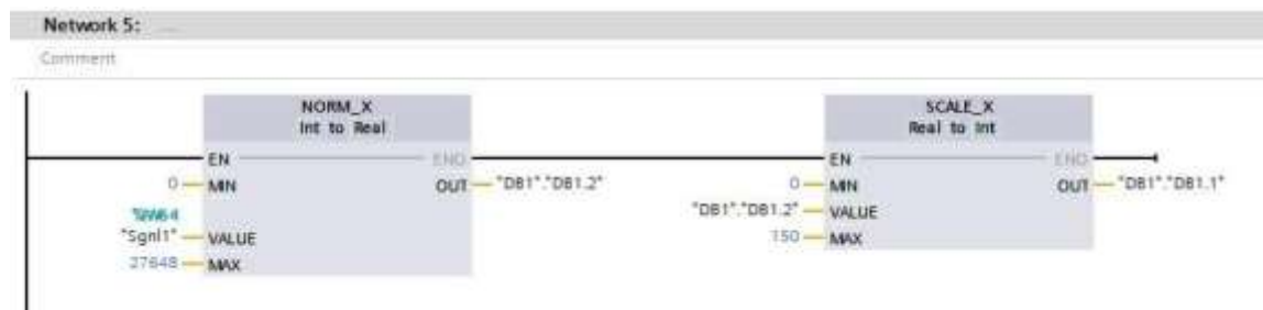
Figura 3. 30. Lectura y conversión de señales analógicas.
