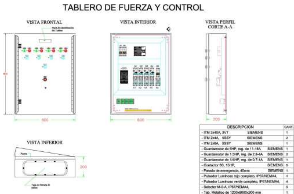
Figura 2. 29. Esquema de tablero eléctrico en AutoCAD.
