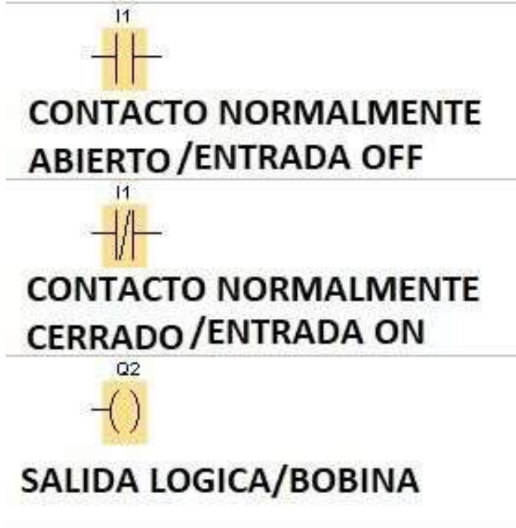
Figura 2. 21. Elementos del lenguaje Ladder.
