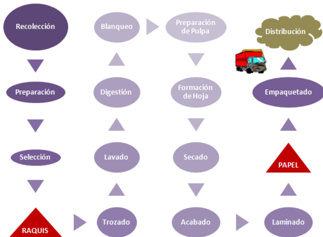
Grafico 4.10. Procesos para la obtención de celulosa para la fabricación de papel a partir de desechos agrícolas del banano
