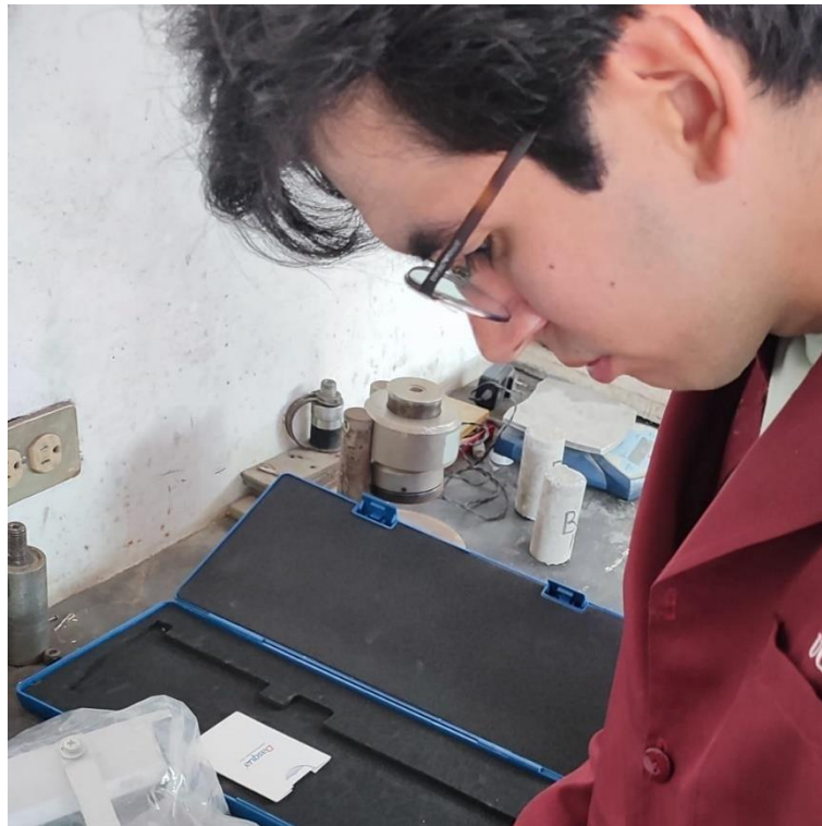
Figura 27. Medición de las alturas de las probetas
