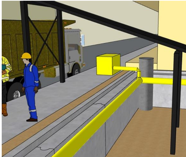
Figura 60. Sistema de rebajamiento de nivel freático mediante el uso de equipos de bombeo y punteras de extracción de agua
