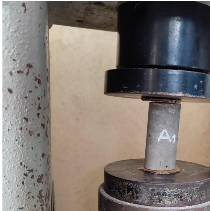
Figura 33. Rotura de probeta de Hormigón Tremie al 7mo día.
