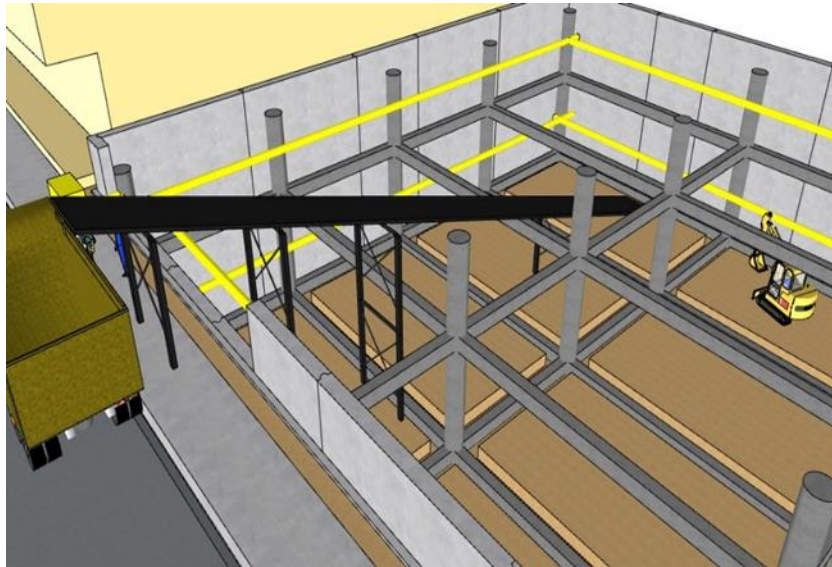
Figura 65. Excavación del piso -2 y fundición de sus respectivas vigas. Se observa el sistema de rebajamiento de agua del nivel freático
