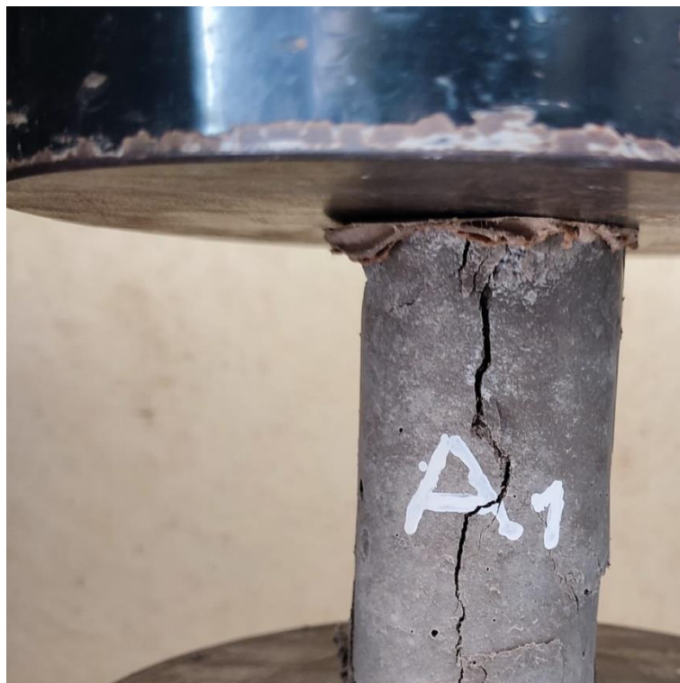
Figura 33. Rotura de probeta de Hormigón Tremie al 7mo día.
