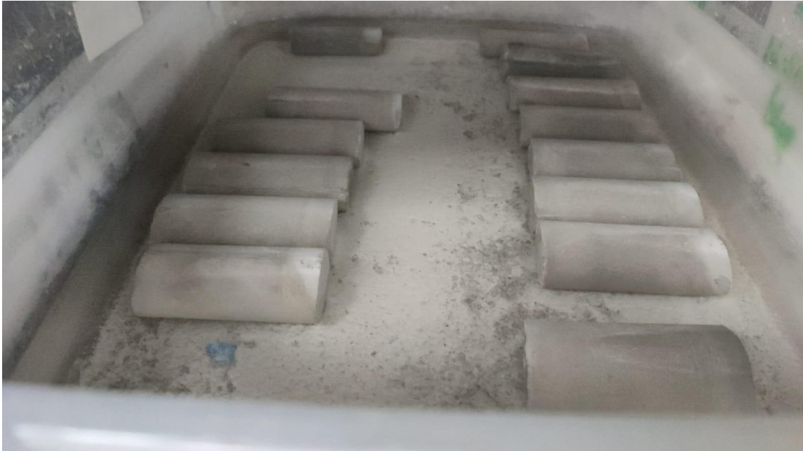
Figura 23. Proceso de curado de las probetas en una piscina
