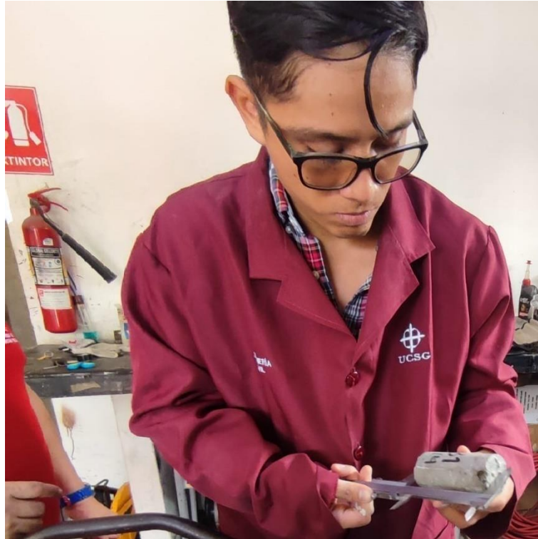
Figura 27. Medición de las alturas de las probetas
