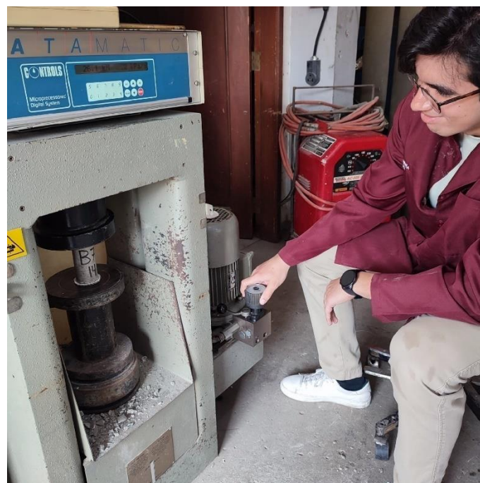
Figura 29. Ensayos a la Compresión Simple a las probetas de hormigón con diseño Tremie.
