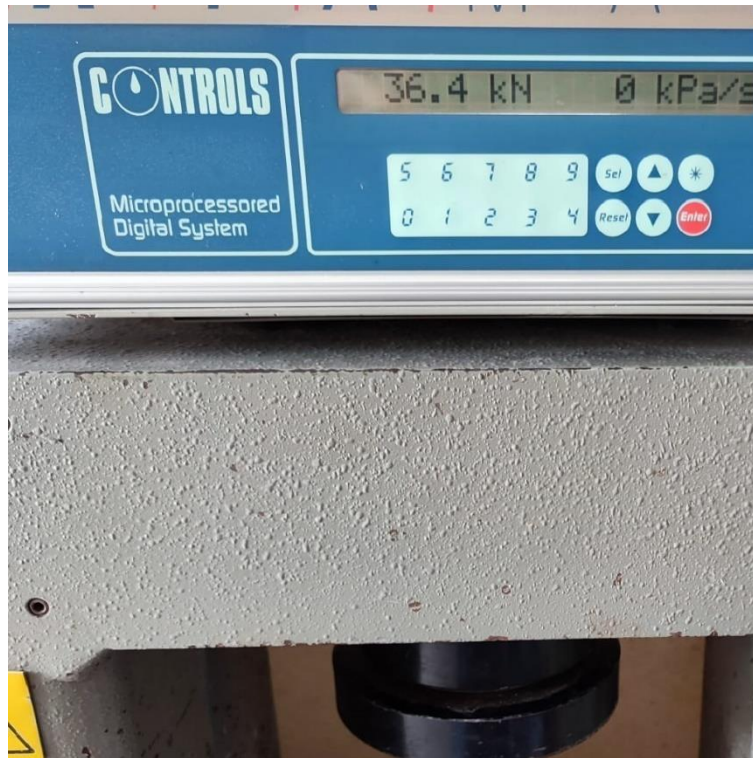
Figura 35. Ensayos de Resistencia a la Compresión Simple
