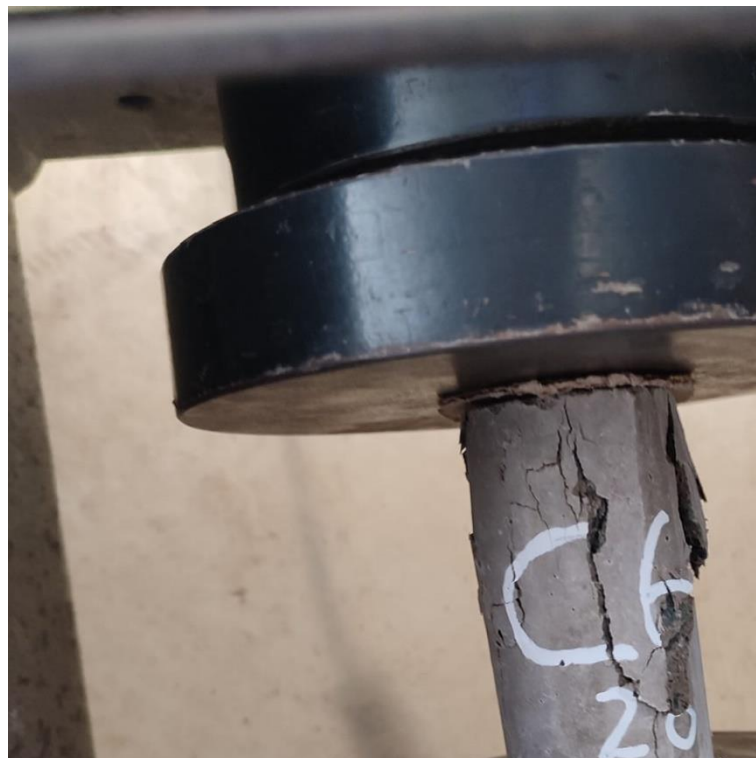
Figura 35. Ensayos de Resistencia a la Compresión Simple
