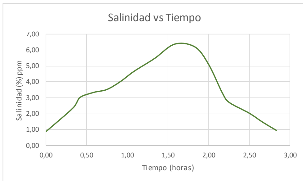
Figura 16 Variación de la salinidad en el efluente del BSI en el segundo muestreo de la Piladora de Cesa.
