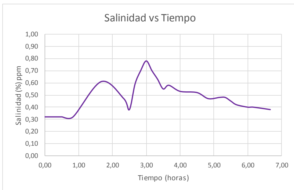
Figura 19 Variación de la salinidad en el efluente del BSI - CDI San Francisco de Cajas.
