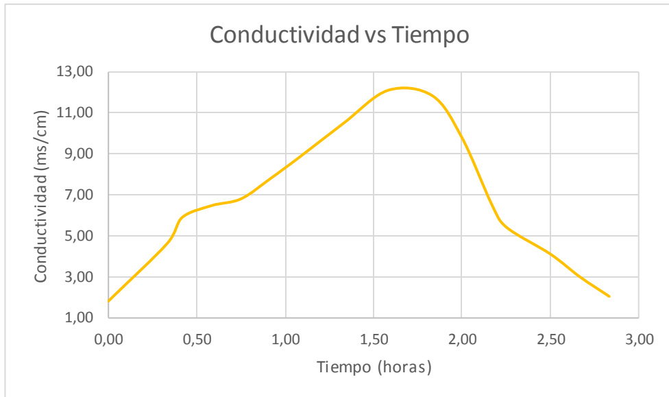
Figura 15 Variación de la conductividad en el efluente del BSI en el segundo muestreo de la Piladora de Cesa.
