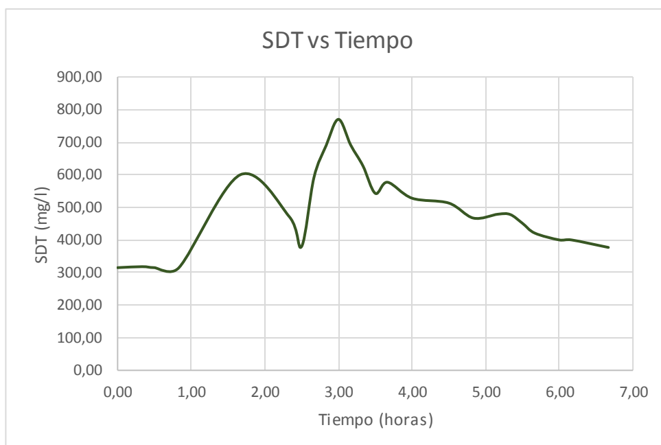
Figura 20 Variación de los SDT en el efluente del BSI - CDI San Francisco de Cajas.
