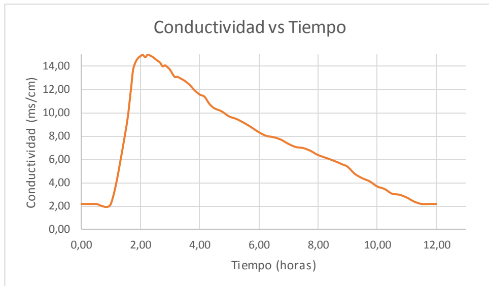
Figura 12 Variación de la conductividad en el efluente del BSI en el primer muestreo de la Piladora de Cesa.
