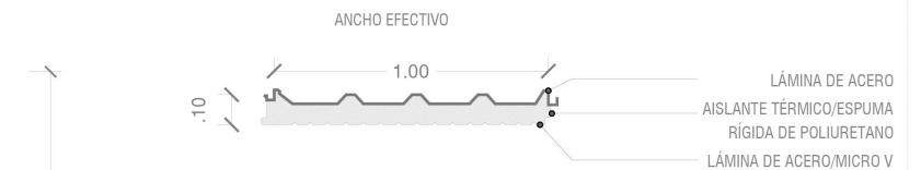
D01.2 PANEL SANDWICH DE UN NÚCLEO DE ESPUMA RÍGIDA Y DOS CARAS DE ACERO ESC: 1:20
