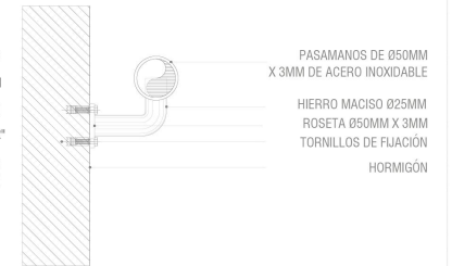
FIJACIÓN EN PARED ESC: 1:20
