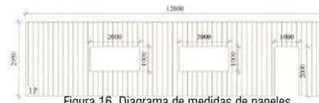
Figura 16. Diagrama de medidas de paneles
