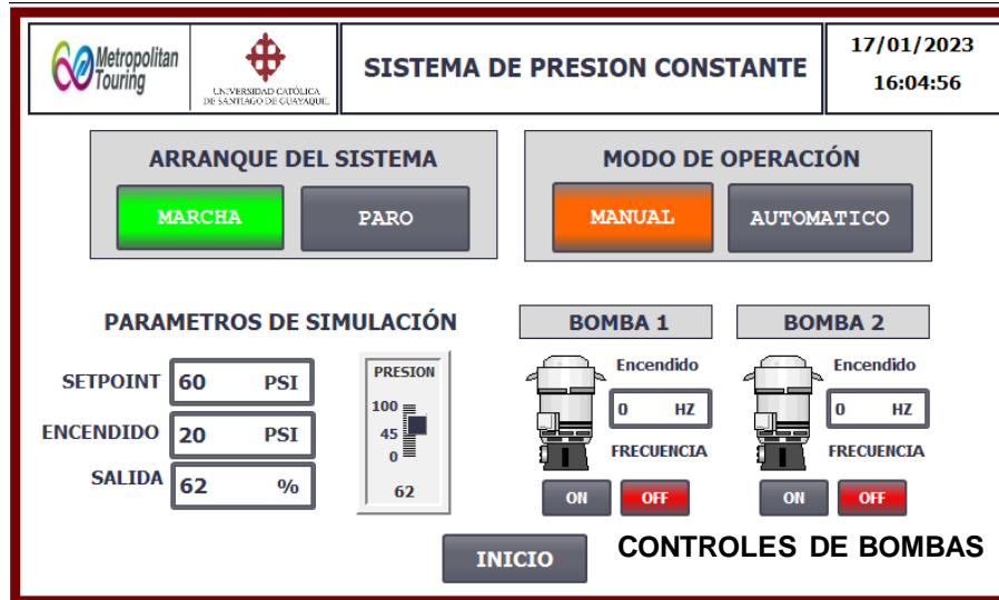
Figura 4. 37 Modo manual-arranque del sistema Fuente: TiaPortal V16 – El Autor
