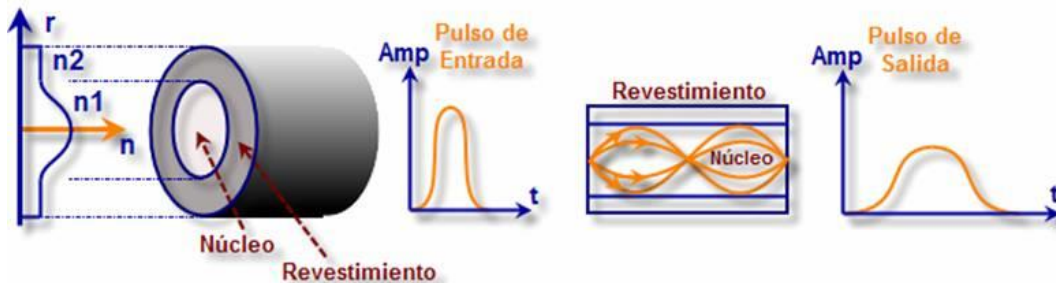
Figura 2. 3: Diagrama de fibra multimodo de índice graduado
