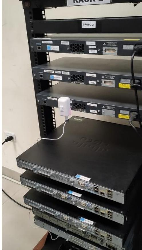
Figura 3.19: Nodo sensor ubicado en el rack.
