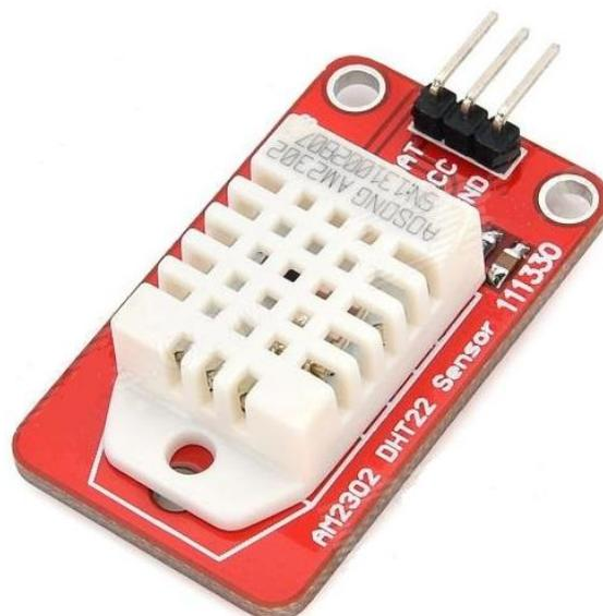
Figura 3.3: Sensor DHT22.
