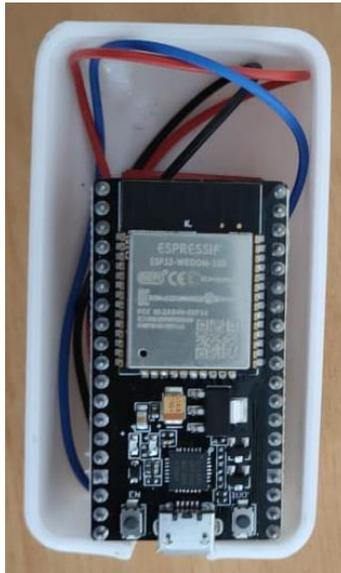
Figura 3.17: ESP32 y DHT22 ubicados dentro del case.
