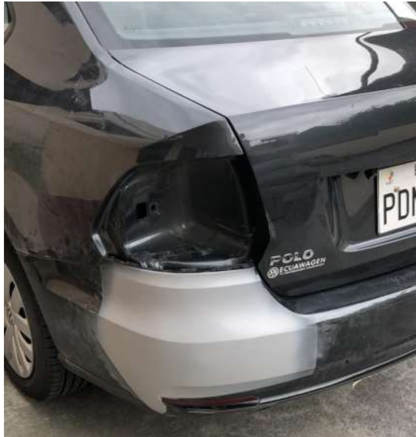
Figura 26. Inicio del proceso de pintura, colocación de base acrílica para pintura.
