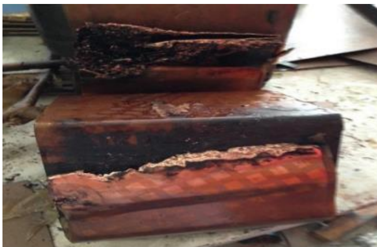
Figura 4. 3 Devanado de alto voltaje dañado por descarga atmosférica Fuente: (Cañizares, 2000)
