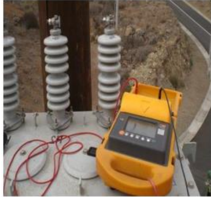
Figura 4. 6 Realización de la prueba de resistencia de aislamiento con el Megger
