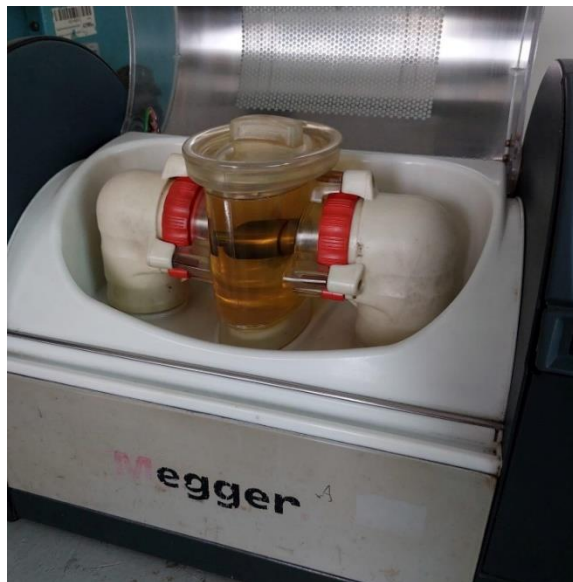
Figura 4. 18 Resultados de la prueba de Megger (aceite dieléctrico), en base a su estado color
