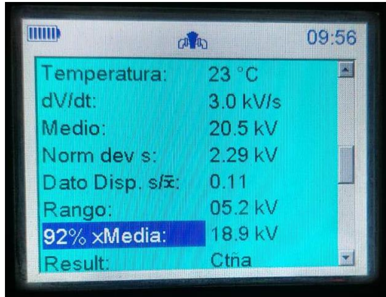
Figura 4. 17 Resultados de la prueba de Megger (aceite dieléctrico)
