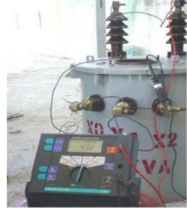
Figura 4. 6 Realización de la prueba de resistencia de aislamiento con el Megger
