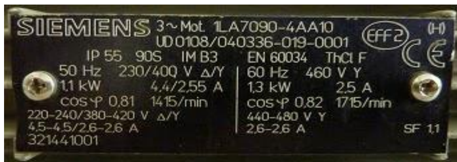
Figura 2.1. Identificación de los datos de placa Fuente: (casares, 2018)
