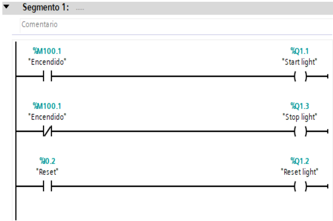
Figura 39: Segmento 1 del bloque piloto
