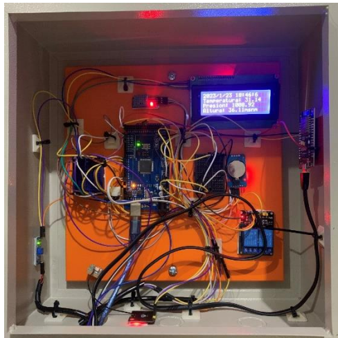
Figura 94: Composición final de los componentes en la estación meteorológica
