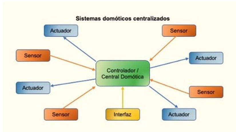
Figura 1: Esquematación de un Sistema domótico Centralizado (Enerxia, 2020)
