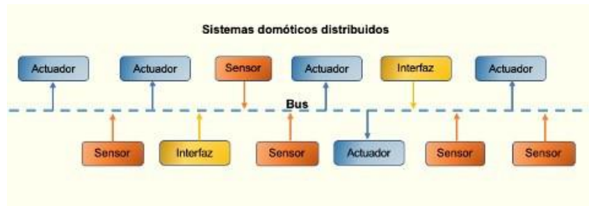
Figura 3: Esquemización de un Sistema domótico Distribuido (Enerxia, 2020)
