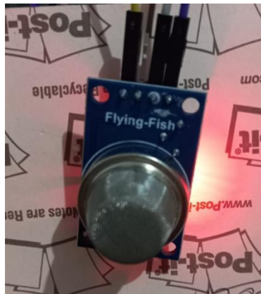
Figura 85: Conexión de pines al sensor MQ2
