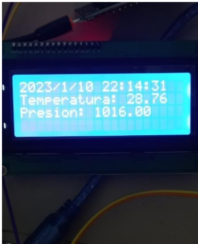
Figura 56: Muestra de datos obtenidos a través de la pantalla LCD
