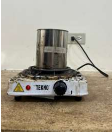
Figura 3.9 Calentamiento del asfalto a 150 °C
