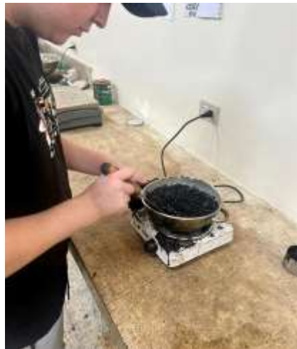
Figura 3.10 Mezcla de los agregados con el asfalto
