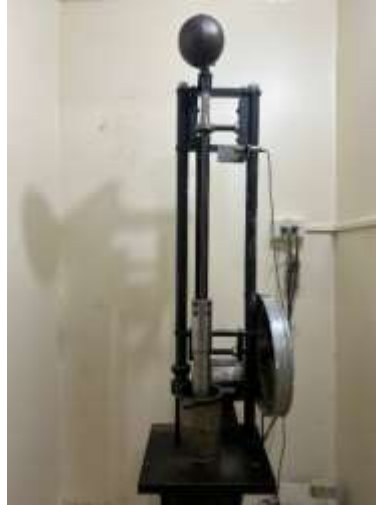
Figura 3.13 Compactación de la briqueta
