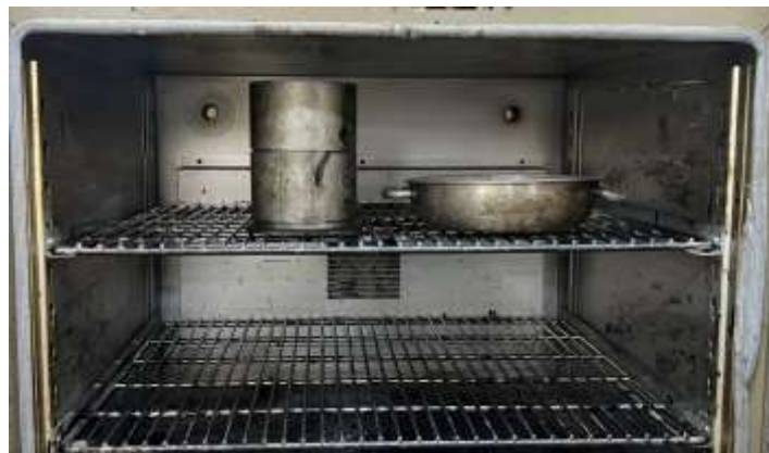
Figura 3.8 Molde y bandeja con los agregados en el horno
