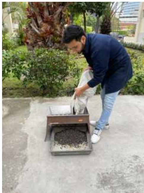
Figura 3.4 Cuarteo del RAP
