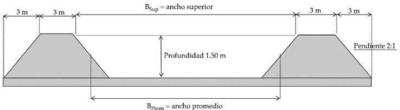
Ilustración 3 - Corte transversal de una laguna facultativa
