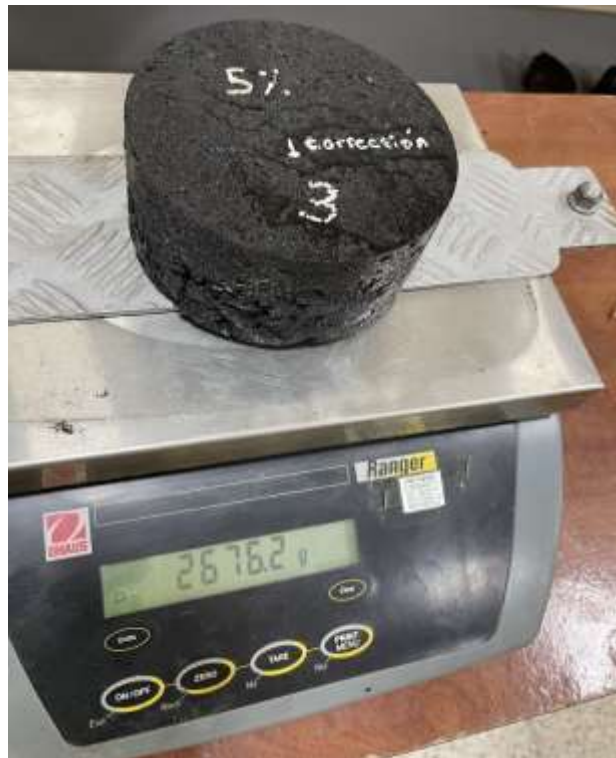
Figura 34.- Pesaje parcialmente seco de probeta
