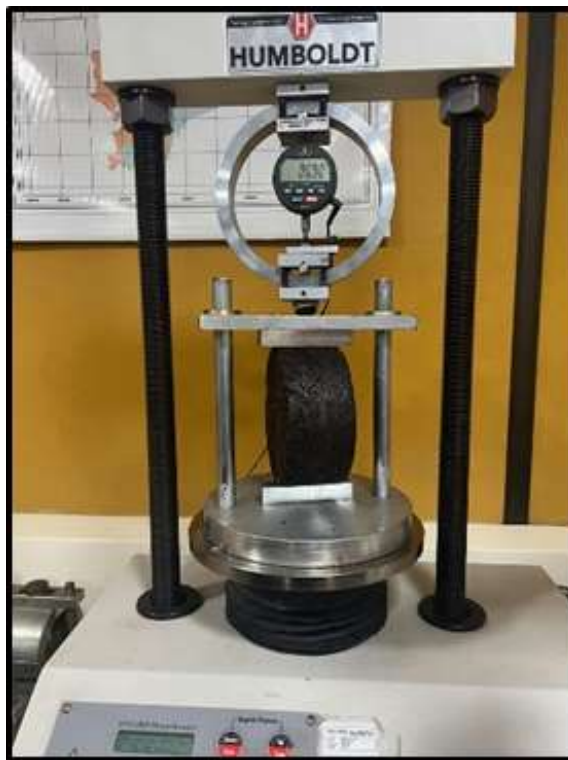
Figura 11.- Prueba IDEAL CT en el Laboratorio de Carreteras de la UCSG.
