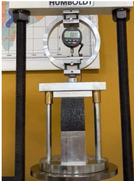
Figura 39.- Colocación de probeta en cabezal para RT Index.
