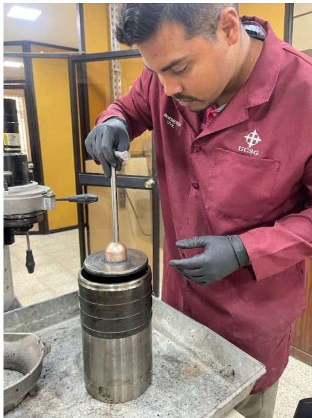
Figura 23.- Colocación de tapa.
