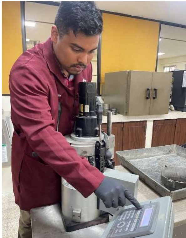
Figura 25.- Programación del compactador giratorio
