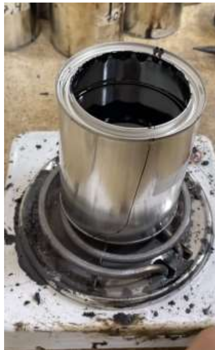
Figura 19.- Calentamiento del asfalto
