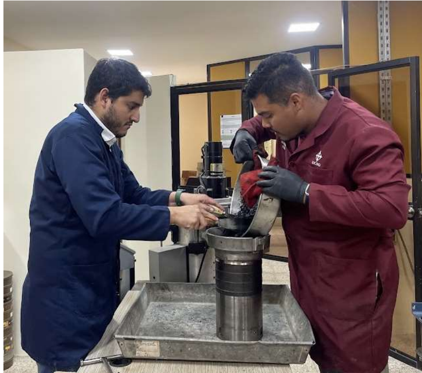
Figura 22.- Colocación de material dentro de molde para compactación giratoria.
