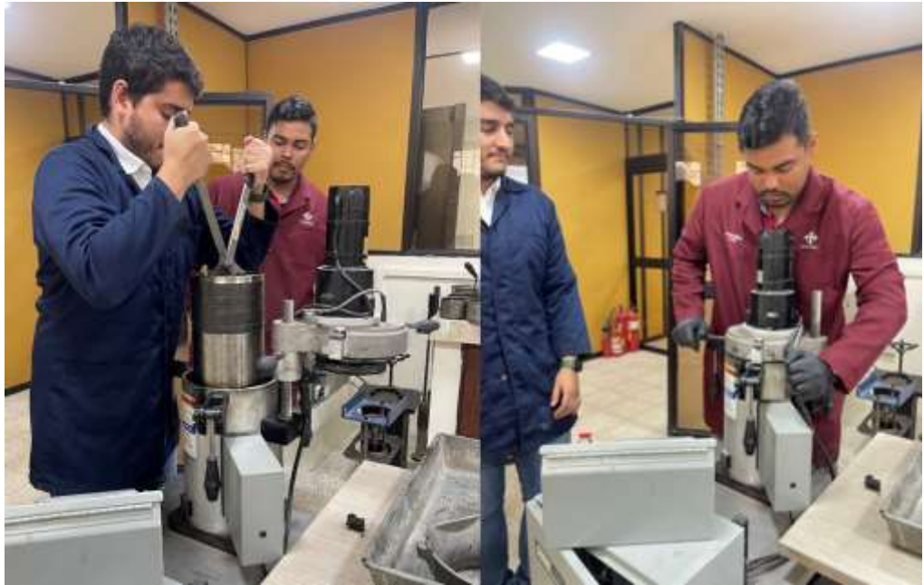
Figura 24.- Colocación de molde dentro de compactador giratorio.
