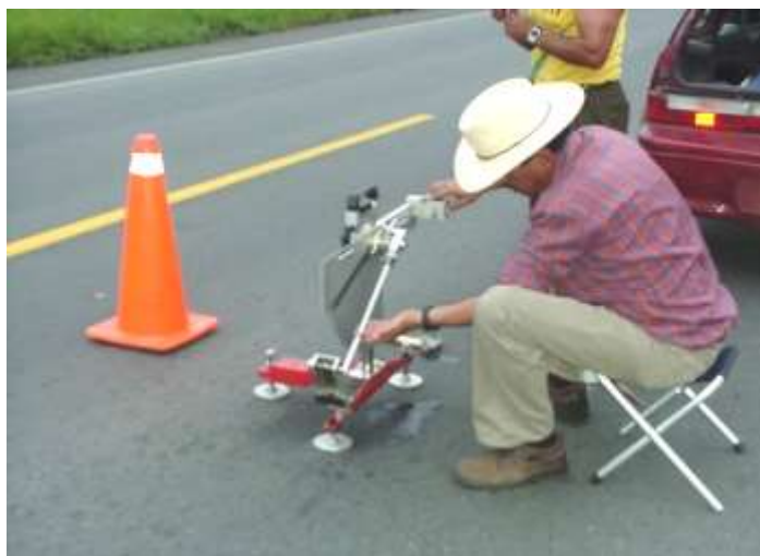
Figura 6.- Medición del coeficiente de fricción con péndulo TRL. - Tomado de: Clases de la asignatura de Pavimentos. UCSG. Ing. Rolando Vila, 2020
