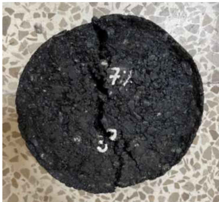
Figura 36.- Espécimen ensayado para CT Index.
