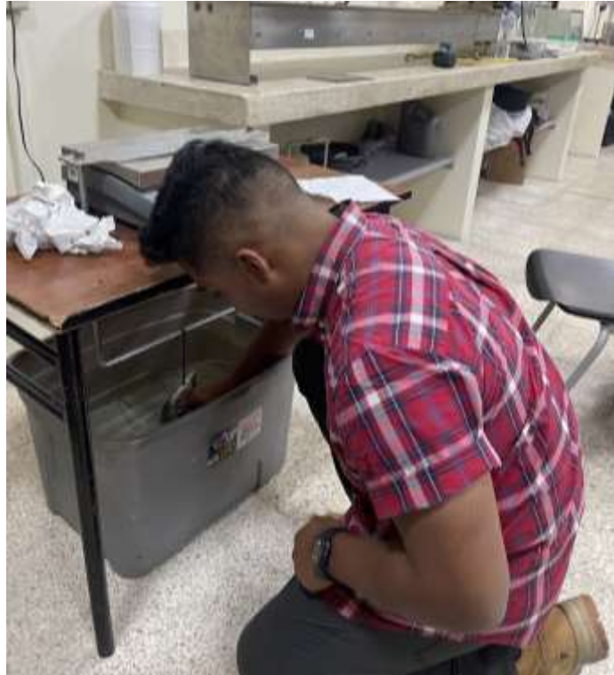
Figura 33.- Pesaje de especímenes sumergidos en agua.
