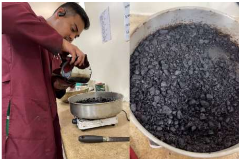
Figura 20.- Mezclado de agregados con asfalto.
