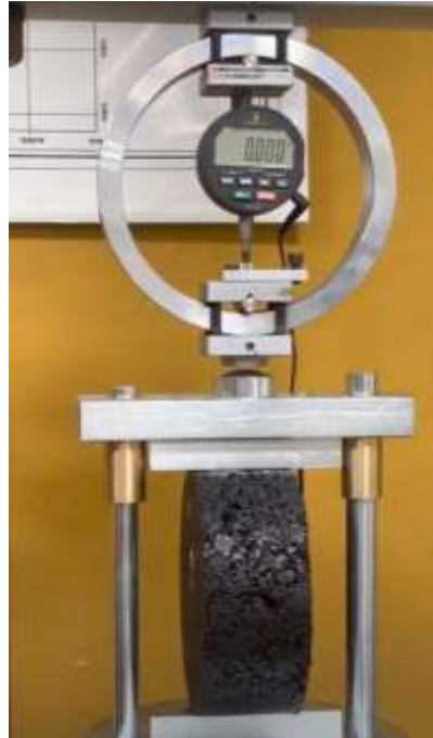
Figura 35.- Colocación de probeta en cabezal para CT Index.
