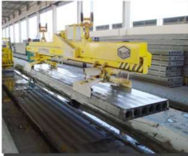
Figura 18. Equipo usado para la elevación de losas alveolares
