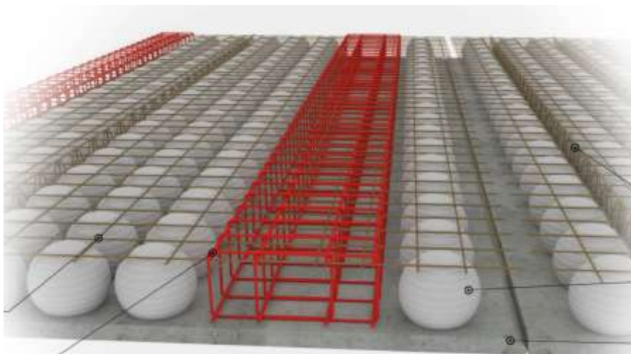
Figura 28. Vista de las vigas “escondidas” en la losa Bubbledeck.
