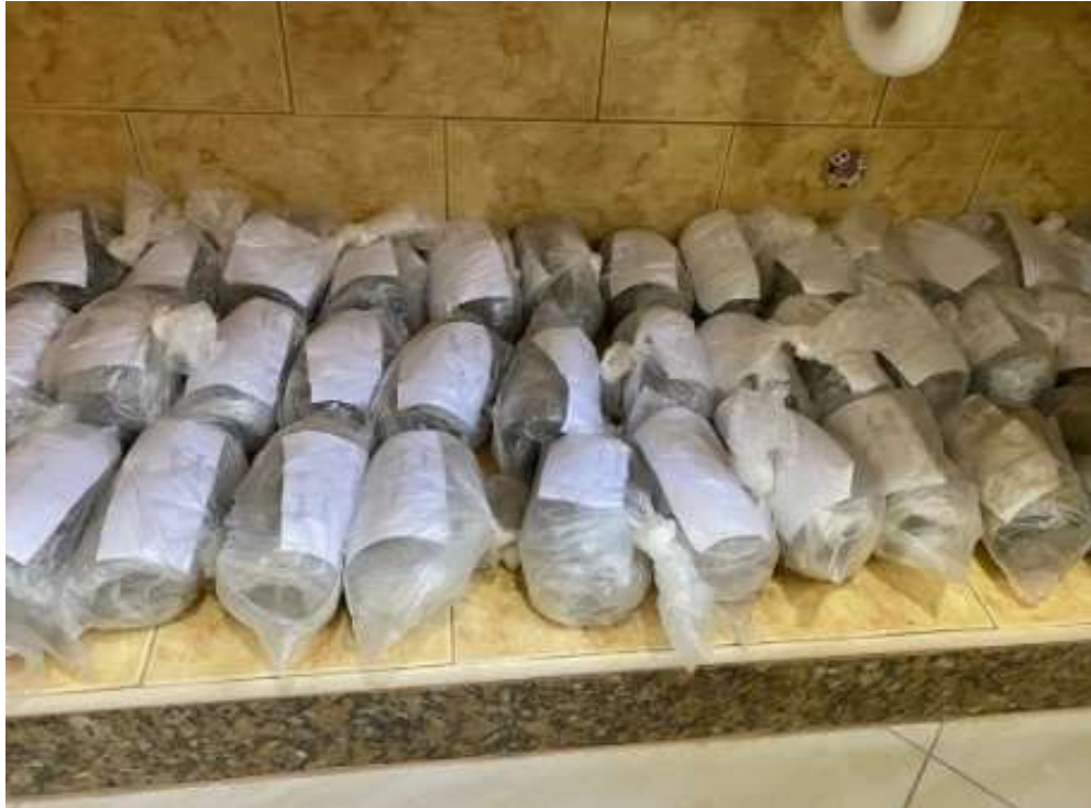
Figura 16 Muestras extraídas con especificaciones ASTM D2166
