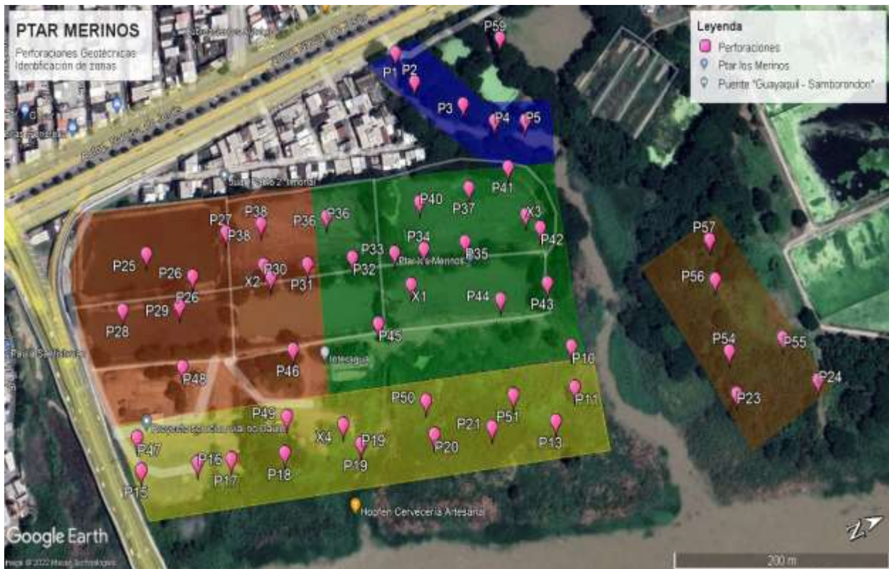
Figura 4 Zonificación de perforaciones PTAR MERINOS
