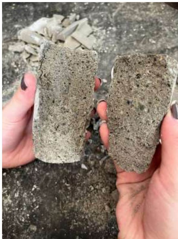
Figura 44. Rotura de probeta. Se observa la granulometría perfecta del mortero de inyección
