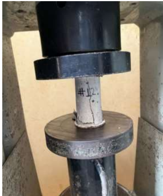
Figura 44. Rotura de probeta. Se observa la granulometría perfecta del mortero de inyección
